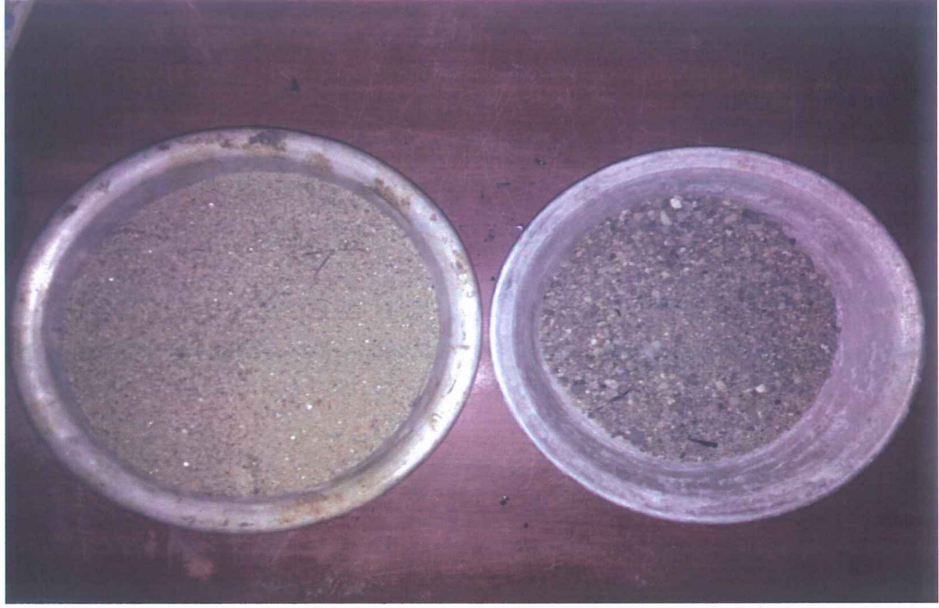
Şekil 6.1: Deneylerde kullanılan SW (sağda) ve SP (solda) zemin numuneleri.
