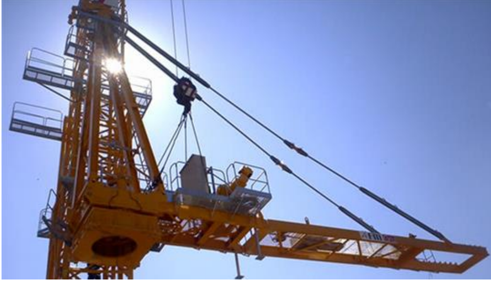
Şekil 2.20: Kule, arka gergi halatı, arka kuyruk.
