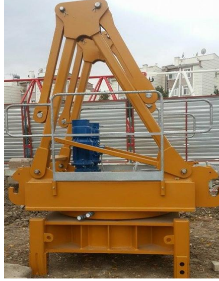
Şekil 2.18: Dönüş göbeği ve dönüş motorları.
