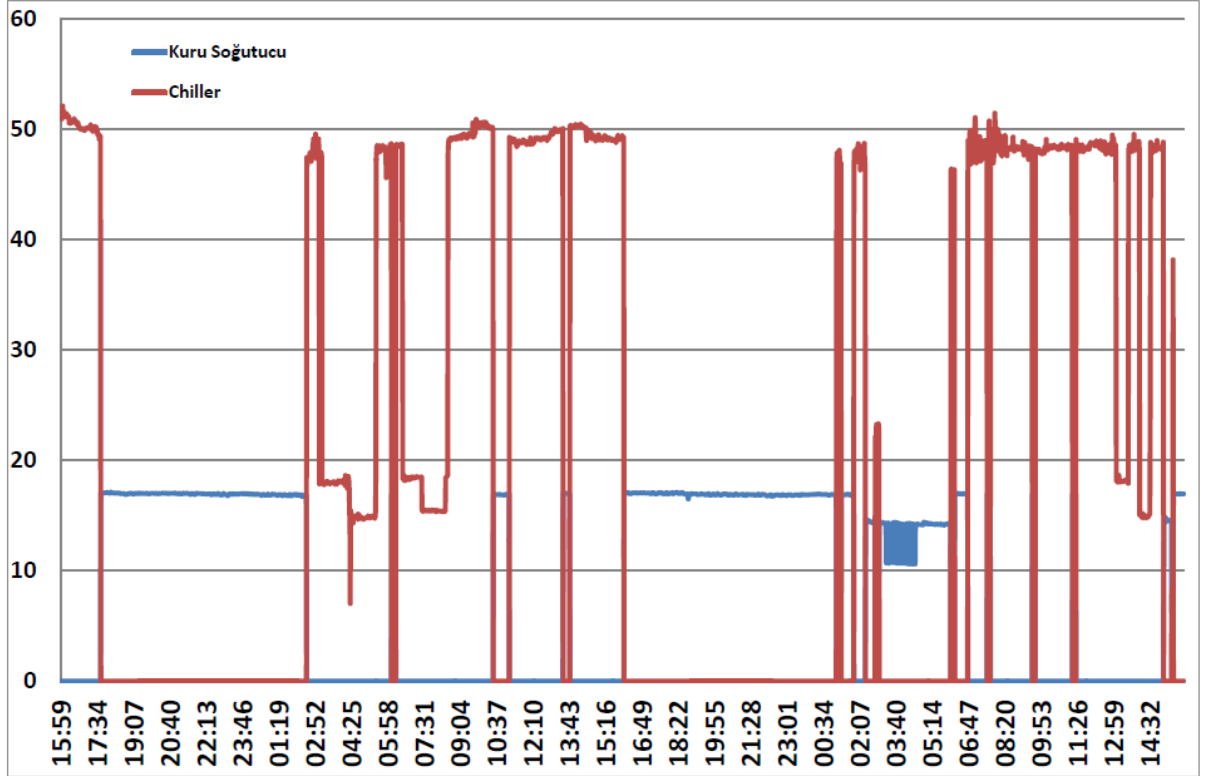
Şekil 4.9: Chiller-Kuru soğutucu geçiş görünümü
