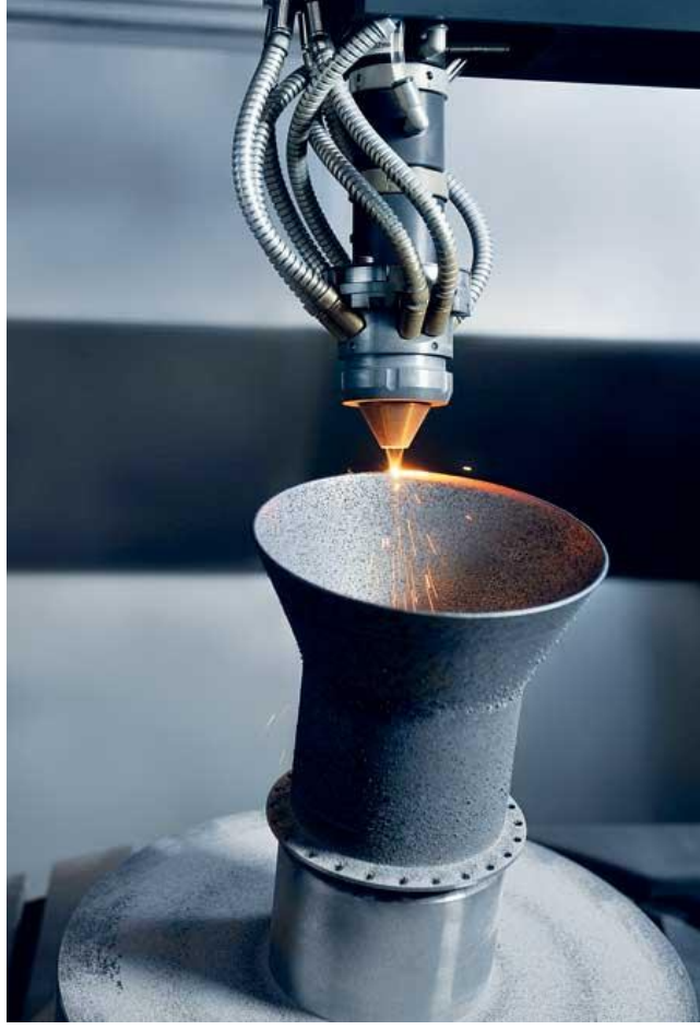
Şekil 2.29: LMD ile üretilmekte olan bir parça [95]
