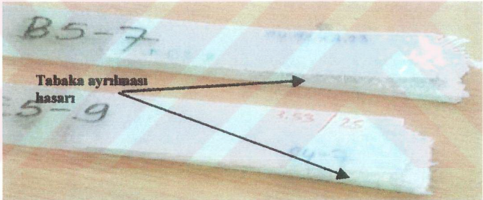
Şekil 6.60 Yorulma testinde tabaka ayrılması (delamination) hasarına uğramış numuneler
