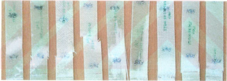
A B C D E F G H K Şekil 6.57 Çekme testi sonucu kırılan numunelerin görüntüsü
