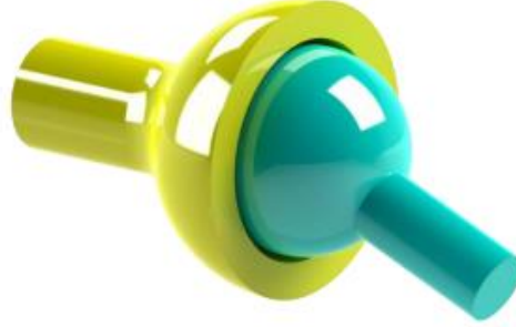
Şekil 2.7: Küresel eklemin yapısı.
