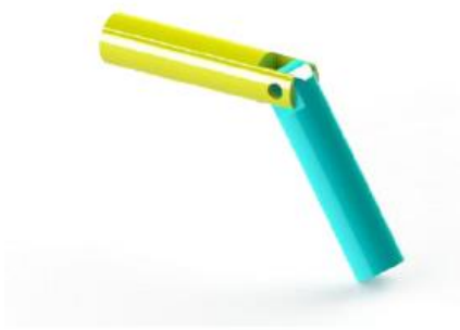
Şekil 2.2: Dönel eklem yapısı.
