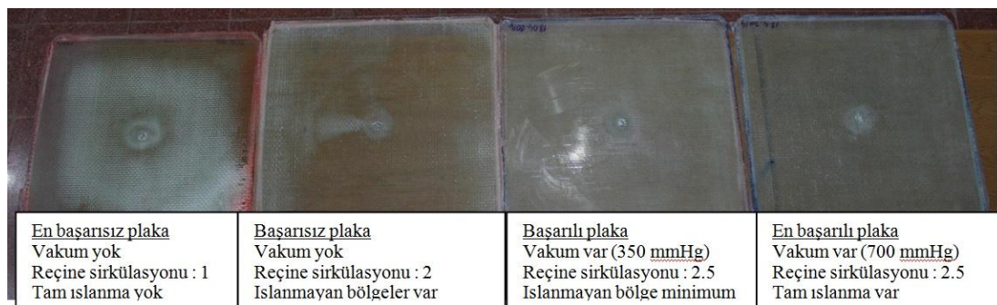
Şekil 6.7: Elde edilen kompozit plaka numuneler.
