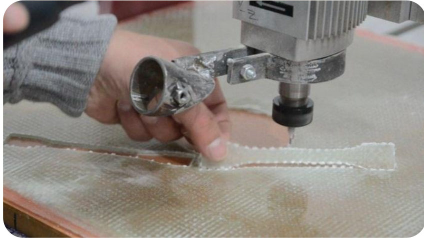
Şekil 6.11: Kompozit plakanın kesimi.
