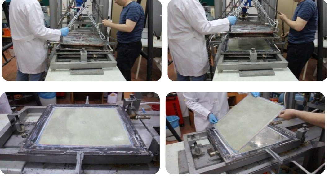
Şekil 6.6: Plakanın kalıptan çıkarılması.
