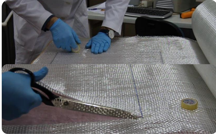
Şekil 6.1: Dokuma elyafların kesimi.
