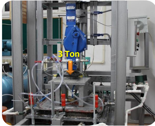
Şekil 6.5: Kütleme basıncının verilmesi.
