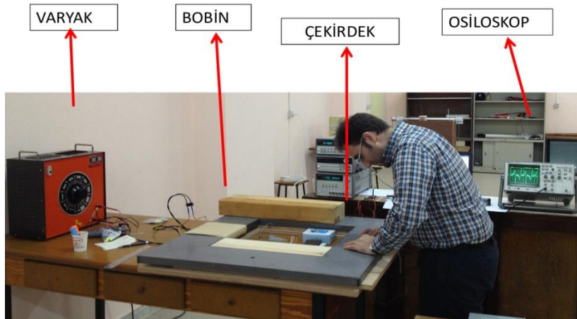
Şekil 2.7: Ölçümler sırasında kullanılan deneysel sistem.
