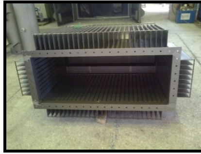
Şekil 1.4: Hermetik transformatör kazanı iç görünümü.
