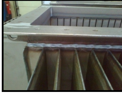
Şekil 1.5: Transformatör kazanının çerçeve ve dalga duvar kaynaklı birleşimi.
