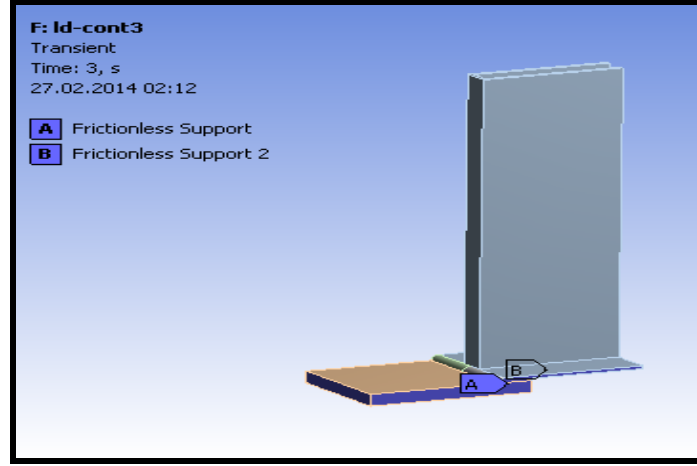
Şekil 3.42: (XRD-4) (DD1100-NPL80) Yapısal analiz sınır koşulları .
