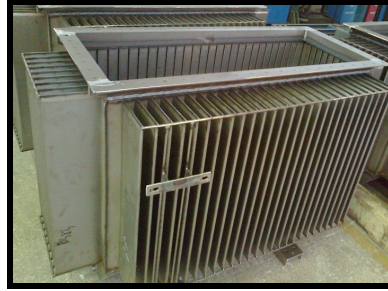
Şekil 2.32: Kendisinden kaynaklı birleşim tiplerine ait Makro İnceleme Numuneleri çıkarılan prototip 2000 kVA transformatör kazanı.
