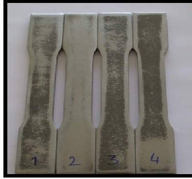
Şekil 2.3: A3 (T6) Malzemeden elde edilen standart çekme testi Kaşık Numuneleri.
