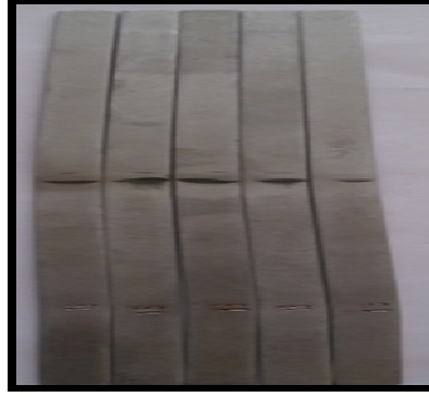
Şekil 2.12: (A2-A2) Eğme Katlama Deney Numuneleri (N16).
