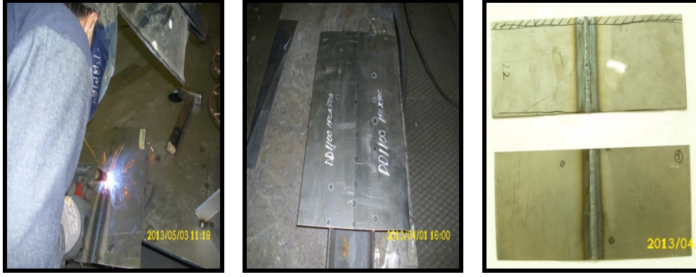
Şekil 2.14: N9 Çekme numunelerinin kaynaklı birleşim çalışması.
