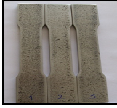
Şekil 2.4: A4 (NPL80) Malzemedan elde edilen standart çekme testi kaşık numuneleri.
