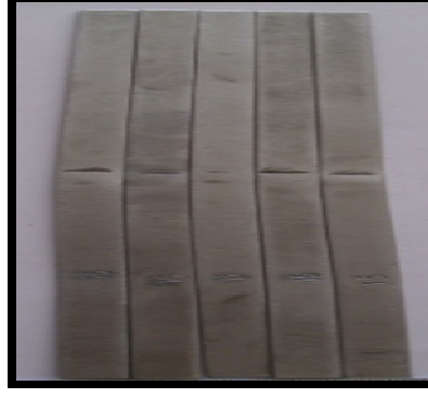
Şekil 2.11: (A1-A1) Eğme Katlama Deney Numuneleri (N15).
