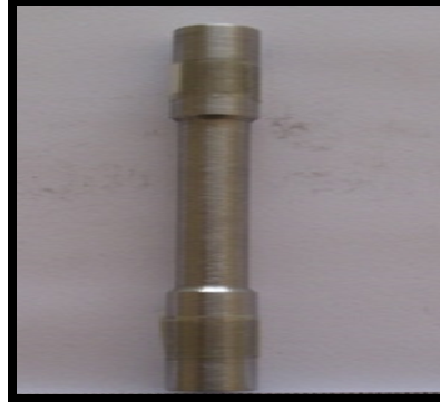
Şekil 2.13: (K1) (K2) (K3) Kaynak Bölgesi Çubuk Numuneleri, kaynak ilave metalinin kendisinden oluşturulmuşlardır.
