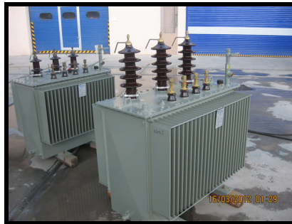
Şekil 1.2: Hermetik tip dağıtım transformatörü.
