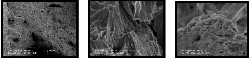
Şekil 2.45: (A4-5) numunesi (B) tarafı kırılma yüzeyleri (50X, 5000X, 10000X).
