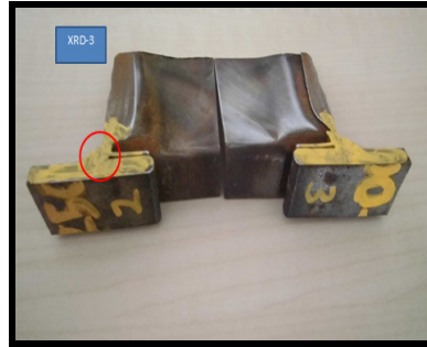
Şekil 2.28: XRD-3 numunesi kalıntı gerilmesi ölçme bölgesi.
