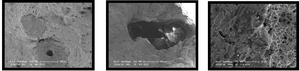
Şekil 2.47: K1 numunesi (B) tarafı kırılma yüzeyleri (50X, 100X, 2000X).
