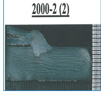
(d) Kaynak bölgesinde yetersiz ergime ve nüfuziyetizlik gözlenmedi. Kaynak bölgesi metalürjik olarak homojendir.
