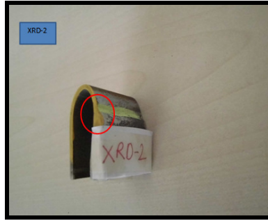
Şekil 2.27: XRD-2 numunesi kalıntı gerilmesi ölçme bölgesi.
