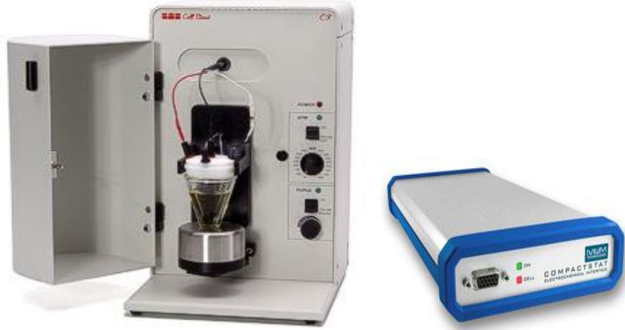
Şekil 2.1: Basi C3 hücre standı ve İvium Compact stat potansiyostat/galvanostat.
