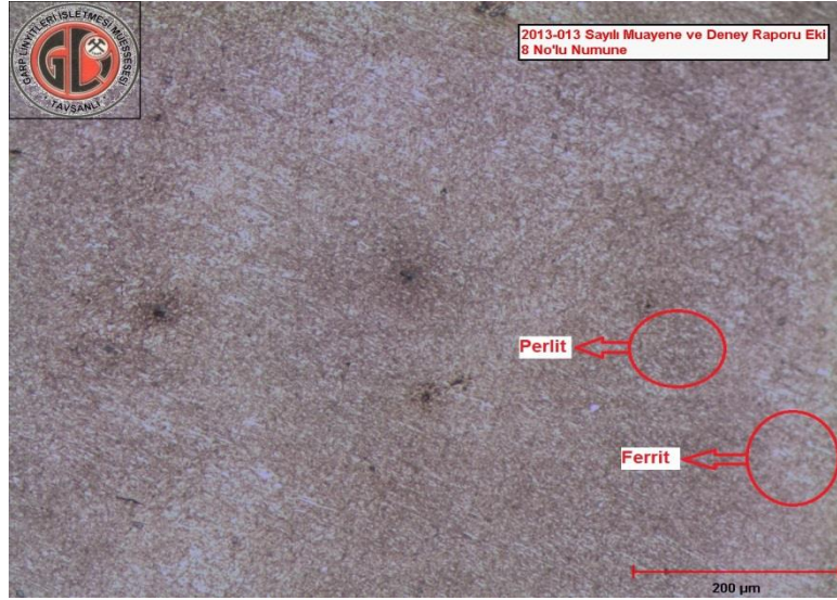
Şekil 5.63: 8 No'lu numune (100X) - Yağ - 600°C temper
