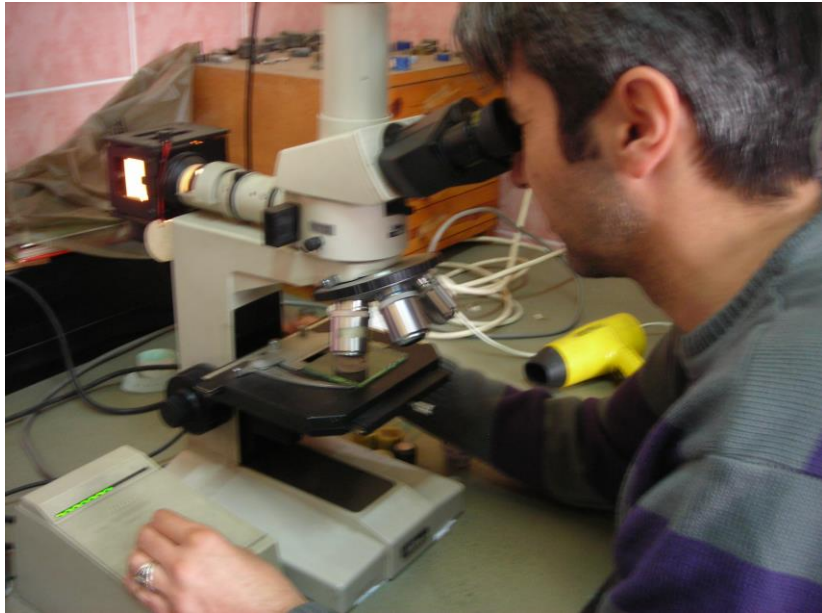
Şekil 5.39: Metal mikroskobunda inceleme
