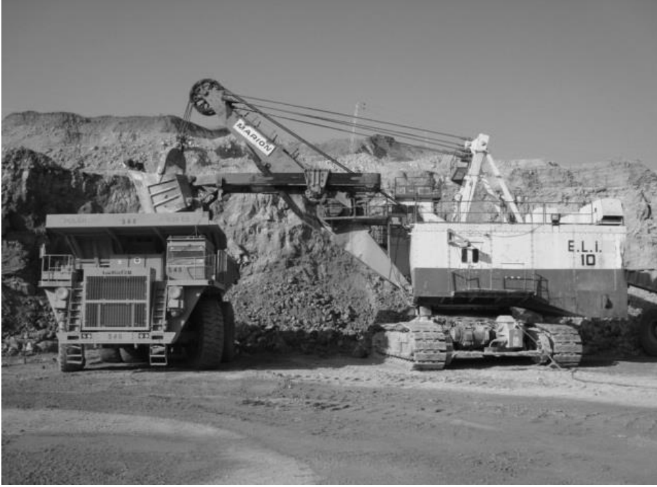
Şekil 2.5: Shovel elektrikli ekskavatör yükleme esnasında
