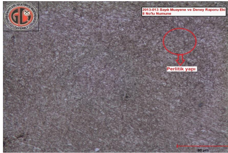
Şekil 5.64: 8 No'lu numune (200X) - Yağ - 600°C temper
