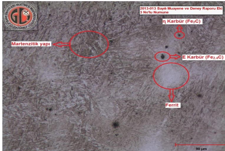
Şekil 5.49: 3 No'lu numune (200X) - Su - 200°C temper
