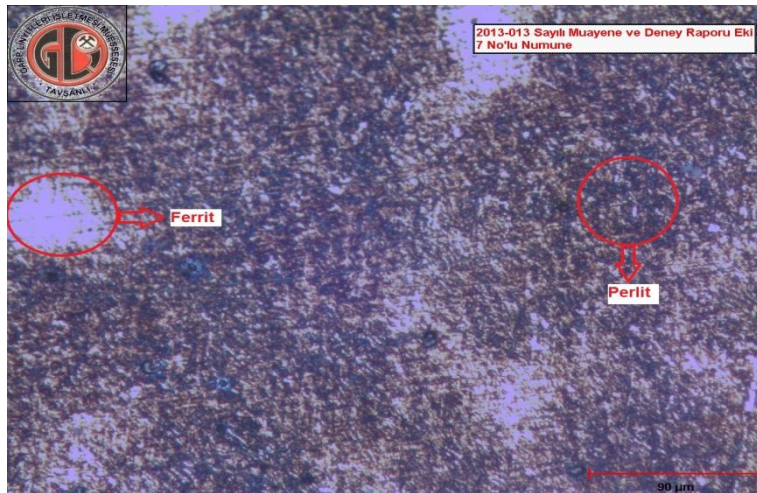
Şekil 5.61: 7 No'lu numune (200X) - Su - 600°C temper
