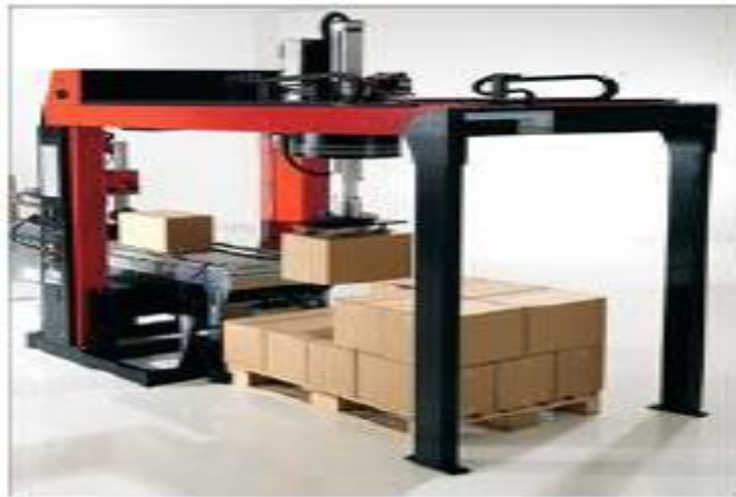
Şekil 4.7: İstif için kullanılan kartezyen robotu örneği.
