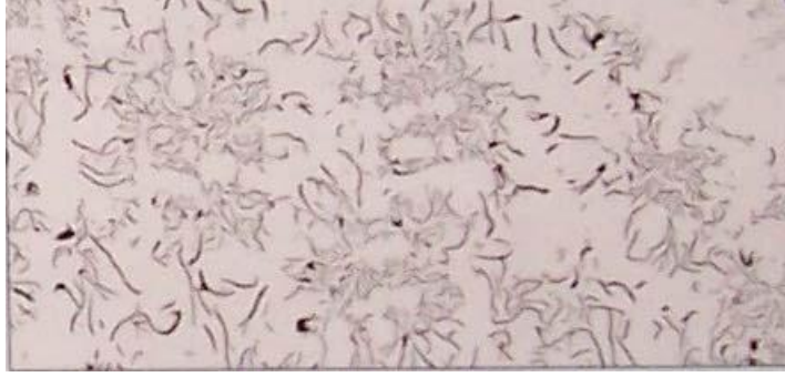
Şekil 4.6: Lamel grafitli dökme demirin yapısında grafit dağılımı
