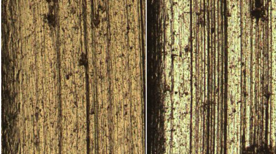
Şekil 6.24: SAE430B disk–GG25 pim aşınma çifti 5000m ve 10000m kayma mesafesinde disk yüzeyinde aşınma izleri.
