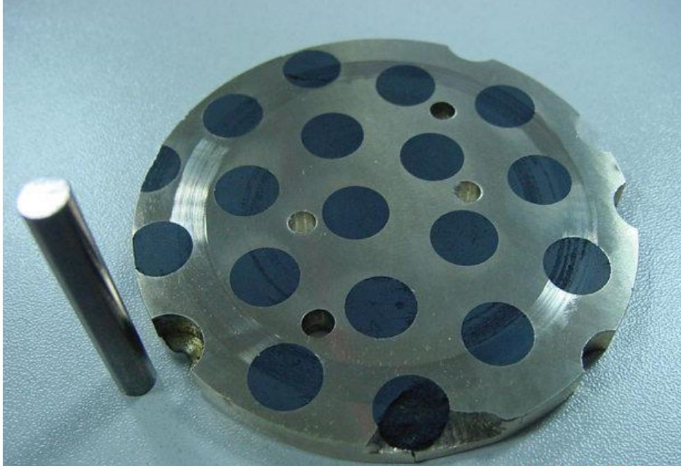
Şekil 6.22: Grafitli SAE430B disk–GGG70 pim aşınma çifti 15000m kayma mesafesi sonrası numunelerin görüntüsü.
