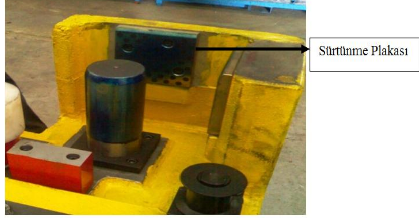
Şekil 4.2: Sürtünme plakasının kalıp içerisindeki konumu
