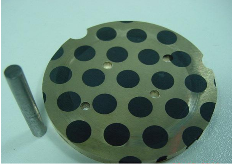
Şekil 6.21: Grafitli SAE430B–GG25 pim aşınma çifti 15000m kayma mesafesi sonrası numunelerin görüntüsü.
