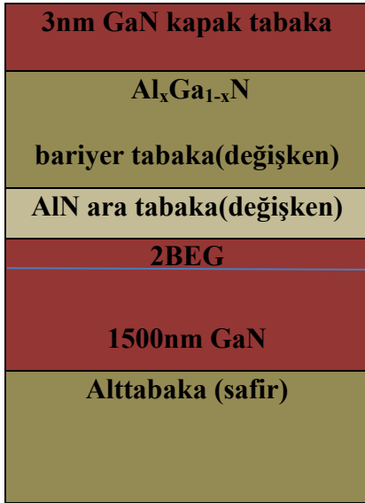
Şekil 3.1: AlGa(In)N/AlN/GaN yapısının geometrisi.
