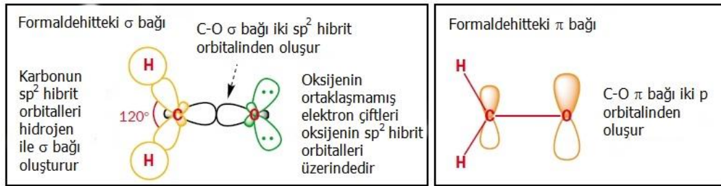
Şekil 1.2: Formaldehitteki \sigma ve \pi bağlarının oluşumu
