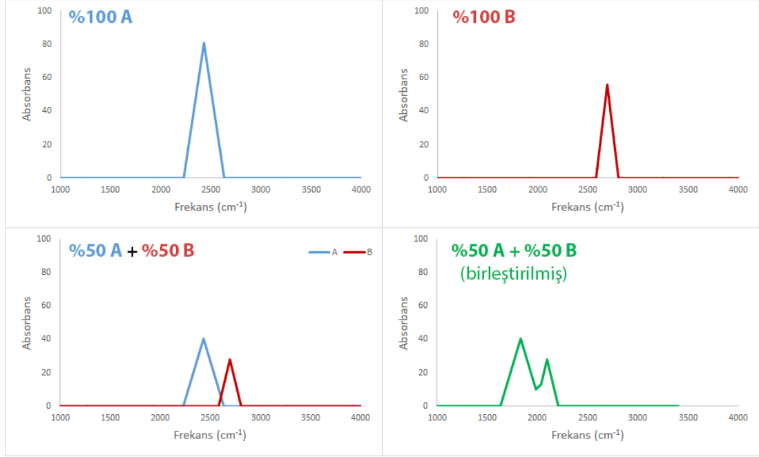
Şekil 2.3: Denge halinde bulunan A ve B maddelerinin ve denge sisteminin tümüne ait şematik infrared spektrumları.
