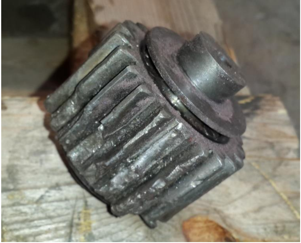
Resim 8.4: Şanzımanın planet dişlisindeki hasar
