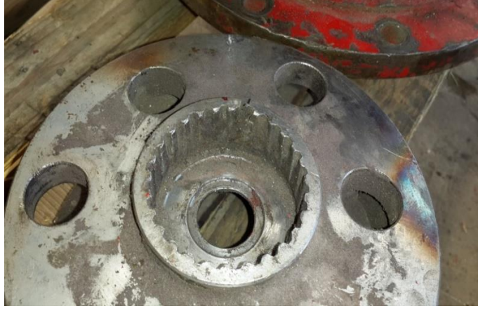
Resim 8.6: Şanzımanın planet taşıyıcısındaki hasar
