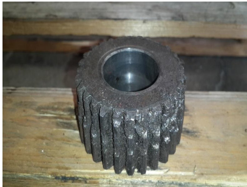
Resim 8.8: Hasar görmüş dişli
