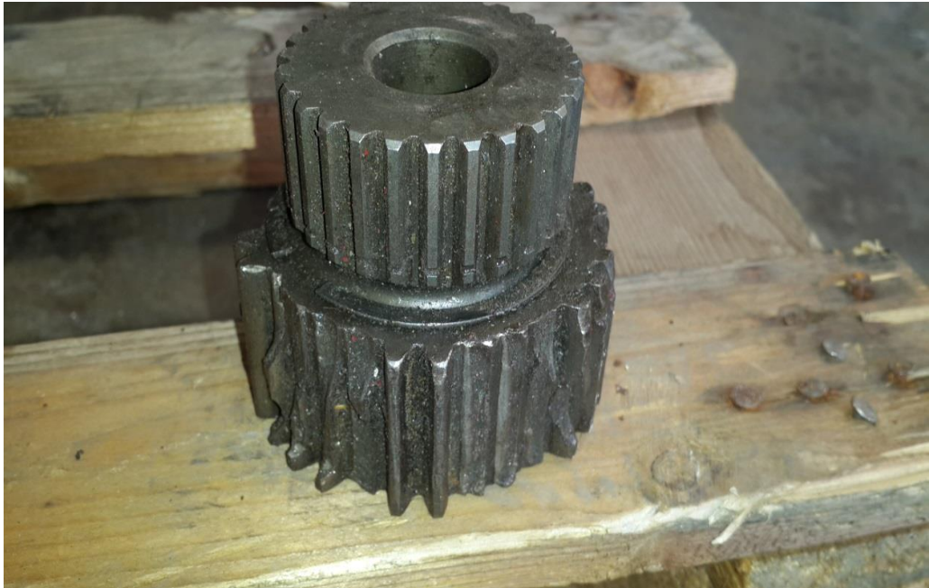
Resim 8.5: Şanzımanın iletim yapan dişlisindeki hasar
