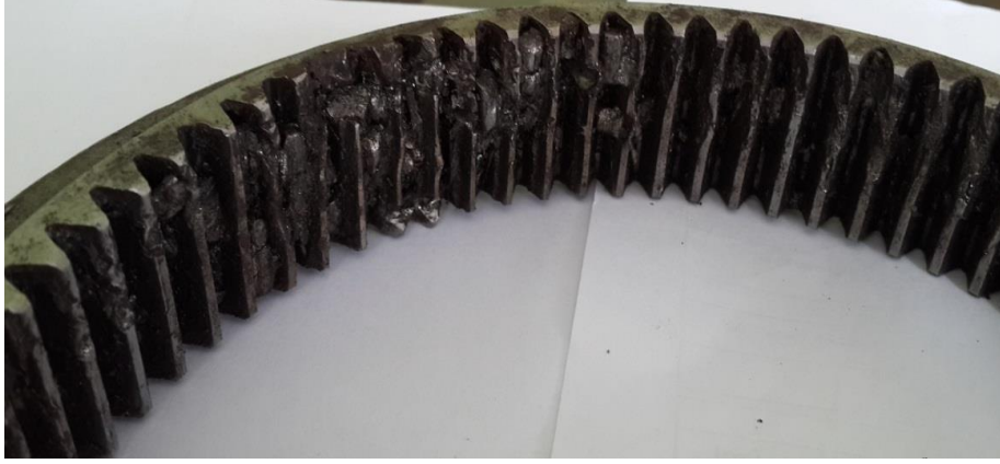
Resim 8.7: Şanzımanın güneş dişlisindeki hasar
