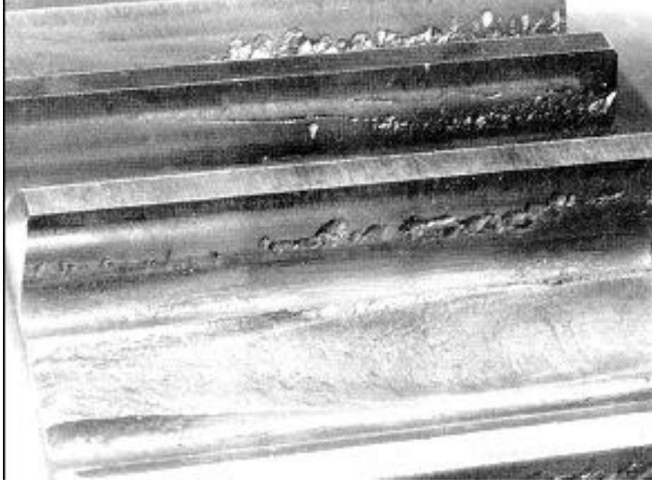
Şekil 7.3: Pitting kaynaklı kırılma
