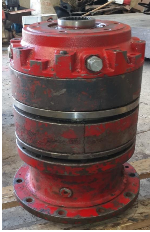
Resim 8.3: Yem karma makinesi planet şanzımanı
