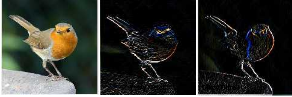
Şekil 6: Sobel Filtresi Uygulaması
