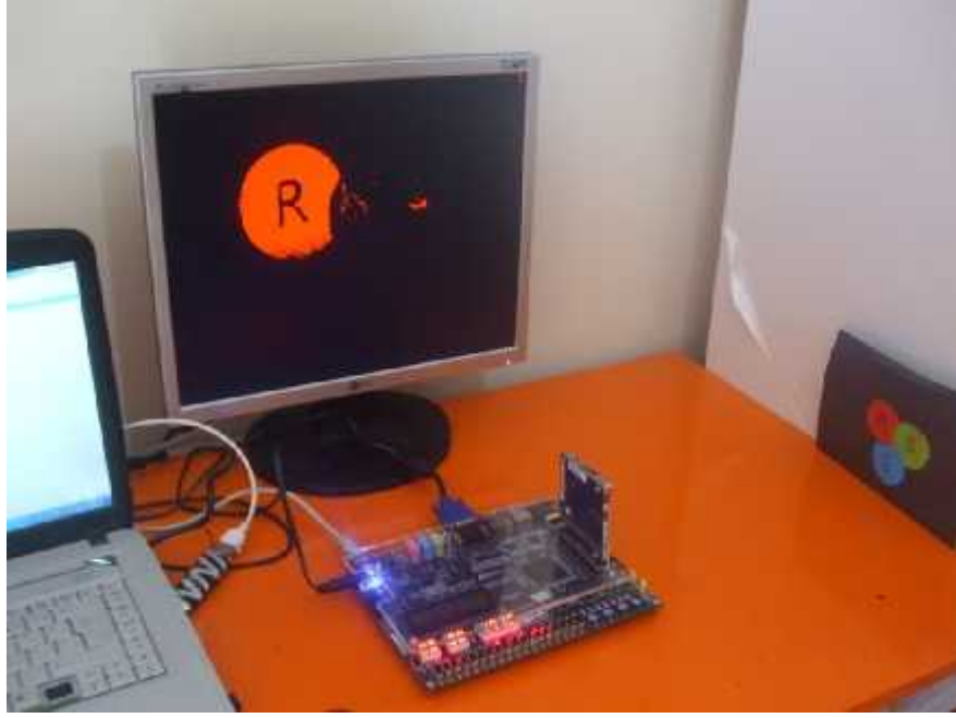
Şekil 95: DE2-115 FPGA ile Kırmızı Filtresi
