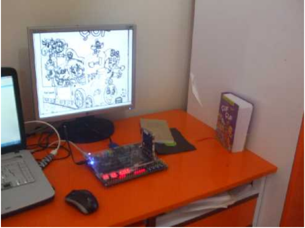
Şekil 97: DE2-115 FPGA ile Sobel Filtresi
