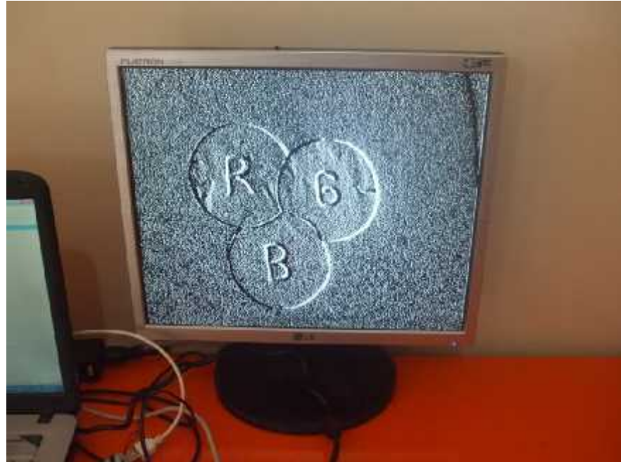
Şekil 96: DE2-115 FPGA ile Emboss Filtresi
