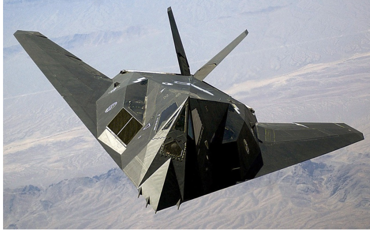
Şekil 2.4: Radar kesit alanının düşürülmesi (F-117A Nighthawk) [7]
