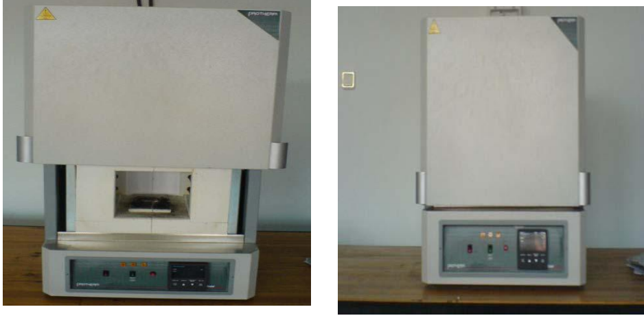
Şekil 6.3. Borlama işleminin yapıldığı fırın.
