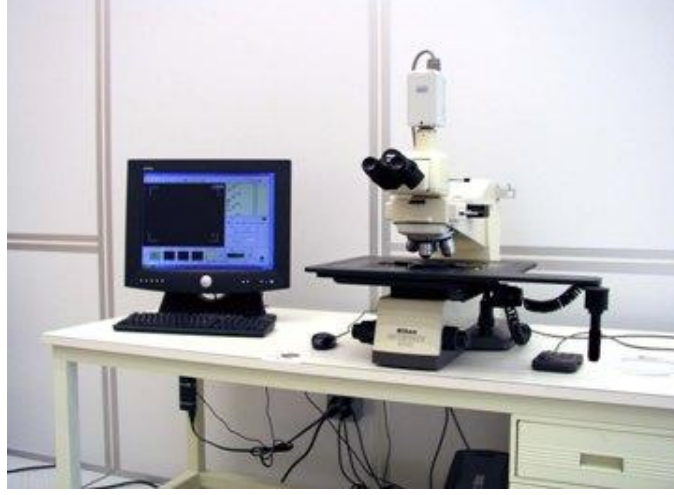
Şekil 6.6. Metalografik incelemede kullanılan Nikon MA-100 marka optik mikroskop.
