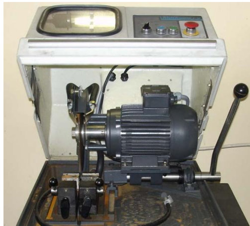
Şekil 6.4. Numunelerin kesilmesinde kullanılan hassas kesme cihazı.
