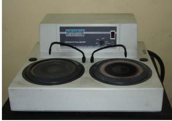
Şekil 6.5. Numunelerin parlatılmasında kullanılan parlatma cihazı.
