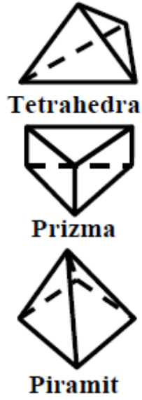
Şekil 4.2 Sayısal ağda kullanılan tetrahedra, prizma, piramit elemanlar.
