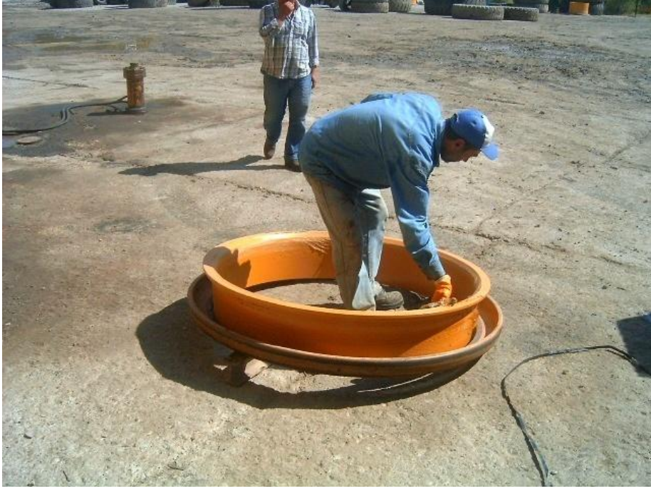
Şekil 7.6: Jant çemberi montaja hazırlanırken
