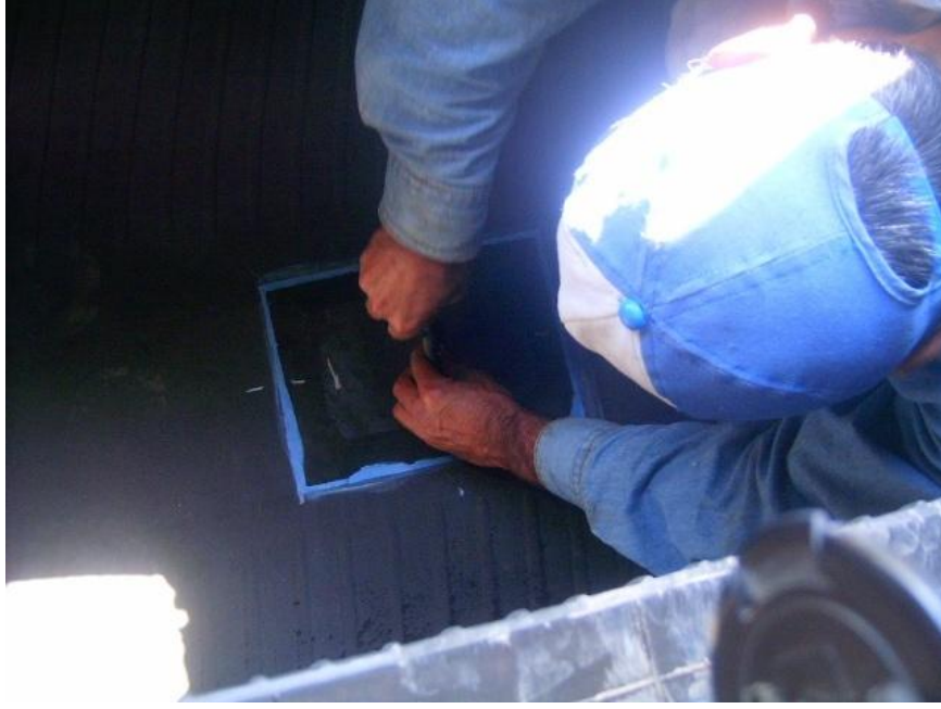
Şekil 7.4: Lastiğin içine civata ile sensör monte edilmiş yama yapıştırılırken Lastiğin içine sensörler yapıştırıldıktan sonra, aşağıdaki resimlerde görülebileceği şekilde lastik toplanmıştır.
