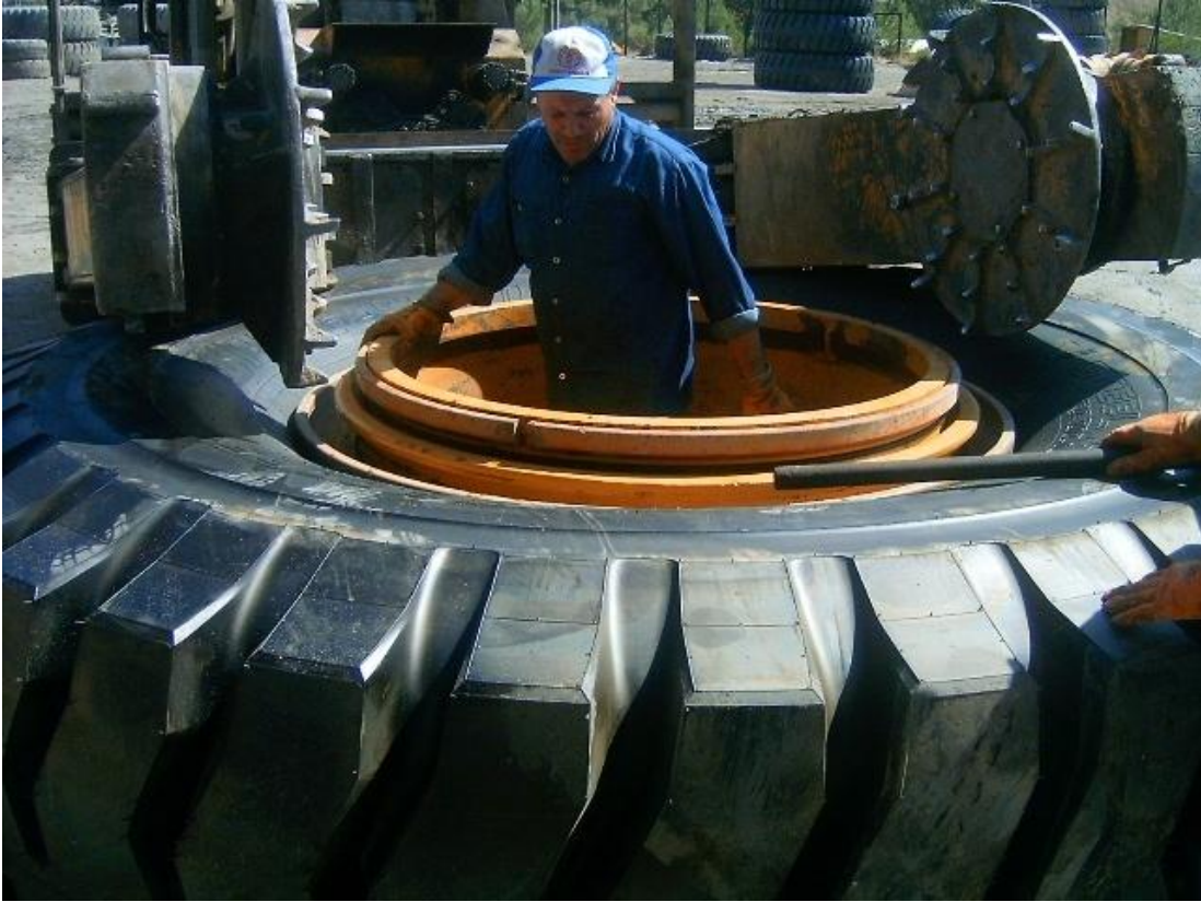
Şekil 7.7: Lastik montajı yapılırken
