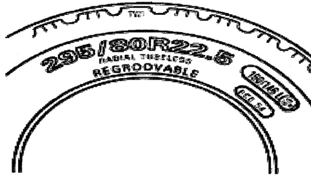
Şekil 2.22: Lastik üzeri bilgileri (otobüs)
