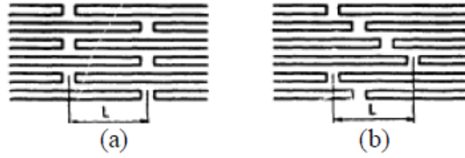
Şekil 7.1: Çekirdek bağlantılarının basit modeli (a) Klasik tasarım (b) Adım kaydırma tasarımı [51]
