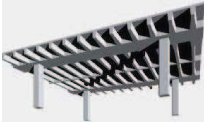
Şekil 1.1: Dişli (asmolen) döşeme sistemi [2]
