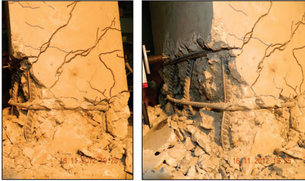
Şekil 2.17: a) %6.0 ötelenme oranında köşe ve orta donatılarda burkulma
