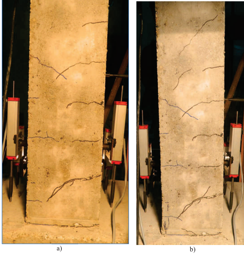
Şekil 2.41:a)%3.32 çekme ötelenme oranında b) %2.02 itme ötelenme oranında
