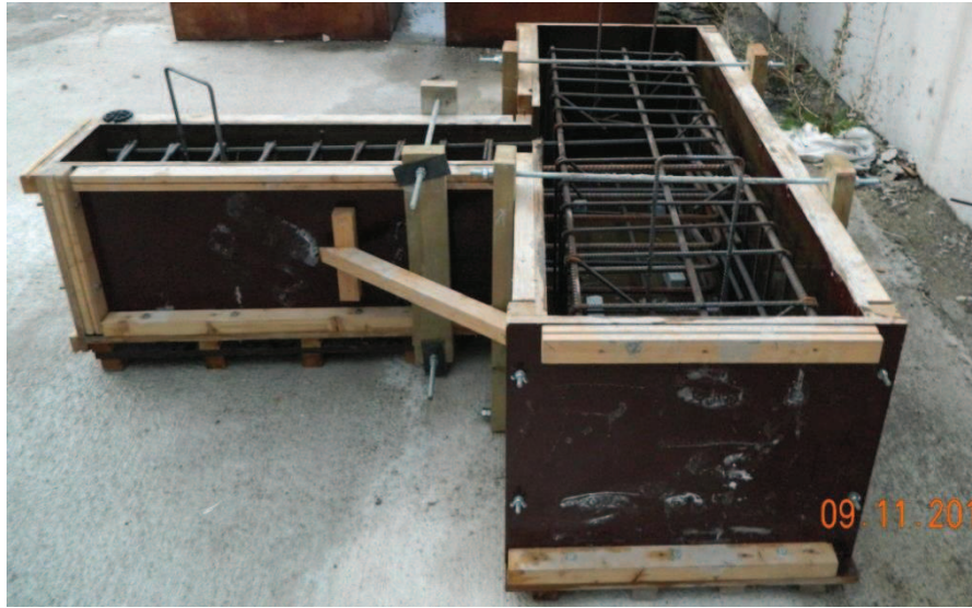
Şekil 2.5: Deney numunelerinin üretiminde kullanılan kalıp sistemi
