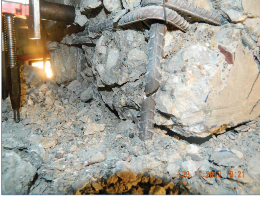
Şekil 2.25: %11 ötelenme oranında boyuna donatıda kopma
