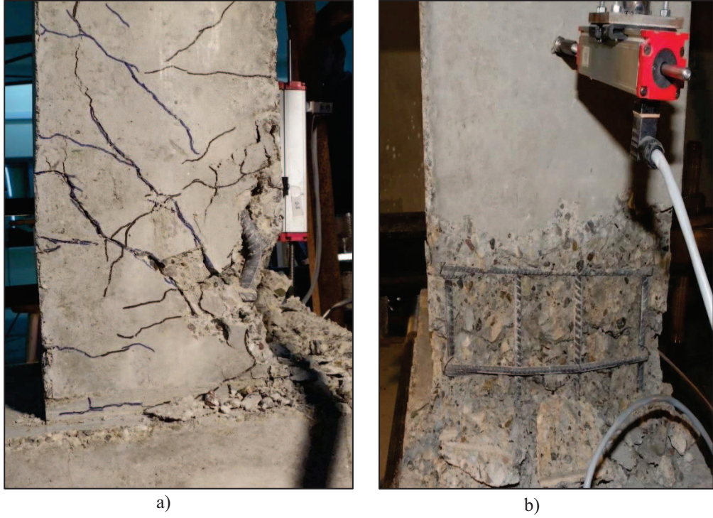
Şekil 2.33: a) Donatılarda burkulma b) Kabuk betonunda dağılma
