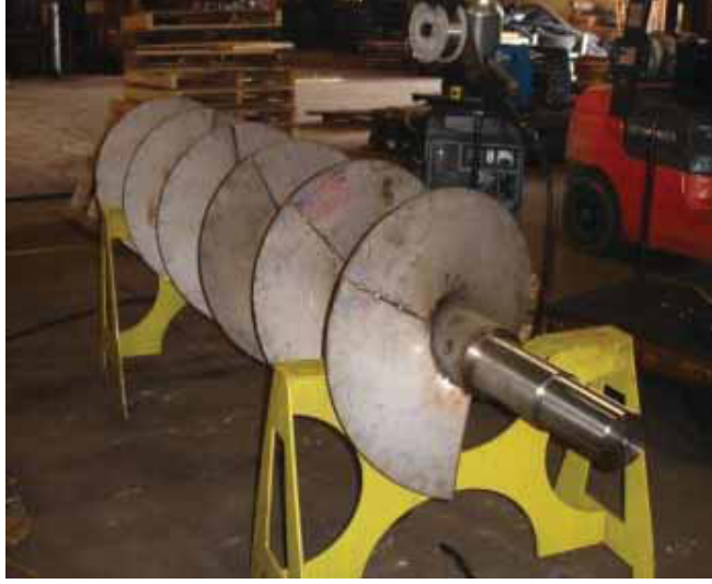
Şekil 3.2 Kaynak bağlantısıyla birleştirilmiş helezon
