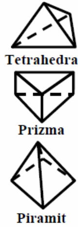
Şekil 4.2 Sayısal ağda kullanılan tetrahedra, prizma, piramit elemanlar. [11]
