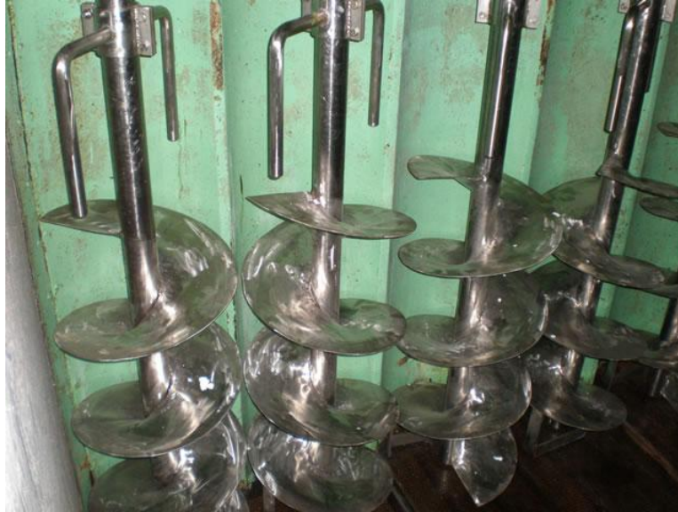
Şekil 3.3 Sürekli Spiral çekme yöntemi ile imal edilmiş helezonlar
