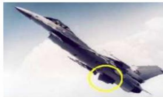
Şekil 3.16 F-16 Uçağı Gövdesinde Partikül Takviyeli MMK Malzeme Kullanımı
