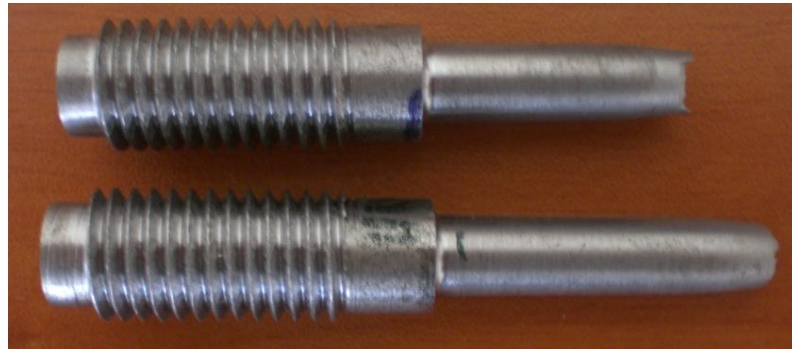
Şekil 5.2 Ç1030 Kopma Resmi
