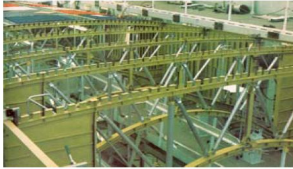
Şekil 3.14 Uzay Mekiği Gövdesinde Kullanılan Bor Fiber Takviyeli Alüminyum Tüpler
