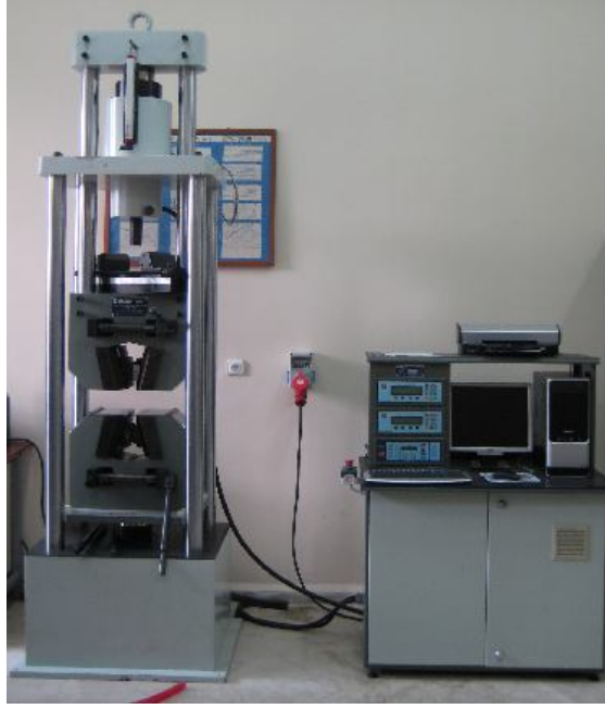
Şekil 5.9 Çekme Cihazı Resmi [48]
