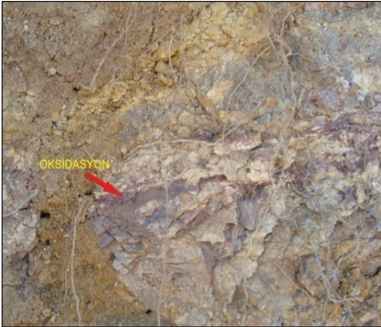
Şekil 3.8 : Yayla melanjı içerisindeki kristalize kireçtaşlarında gözlenen oksidasyona görüntüsü (Yer:değirmen boğazı mesire alanı ).
