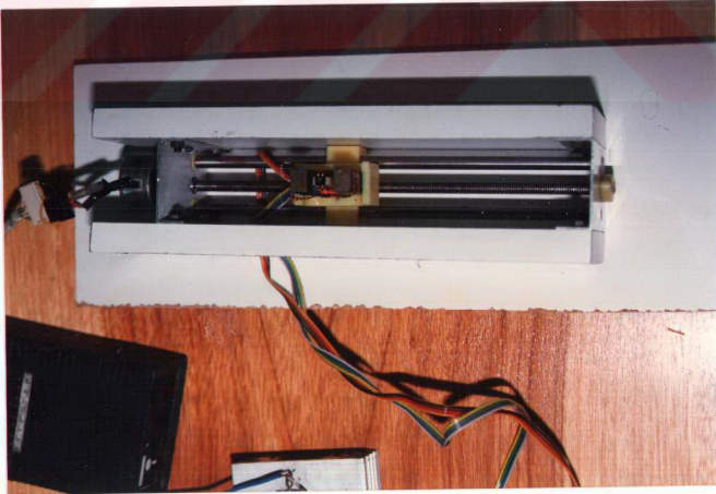
Şekil 2 Bilgisayar kontrollü çatlak dedektörü prototipinin alttan görünüşü
