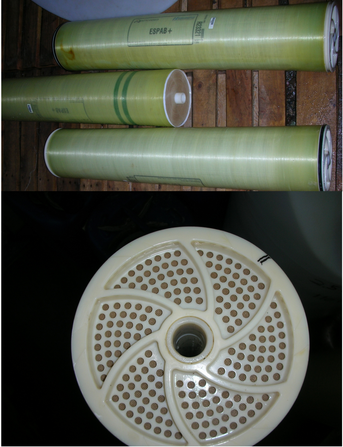
Şekil 3.11 Mobil Pilot Arıtma Tesisi'nde kullanılan membranlar a) Yandan görünüm b) Üstten görünüm
