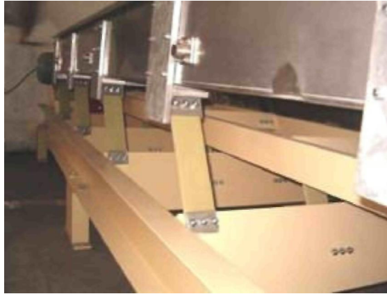
Şekil 3.5 Titreşimli konveyörlerde kullanılan kompozit yaprak yaylar
