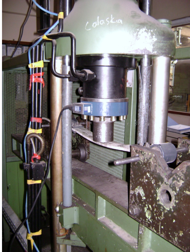
Şekil 10.13 1500N yük altında yaprak yay numunesi
