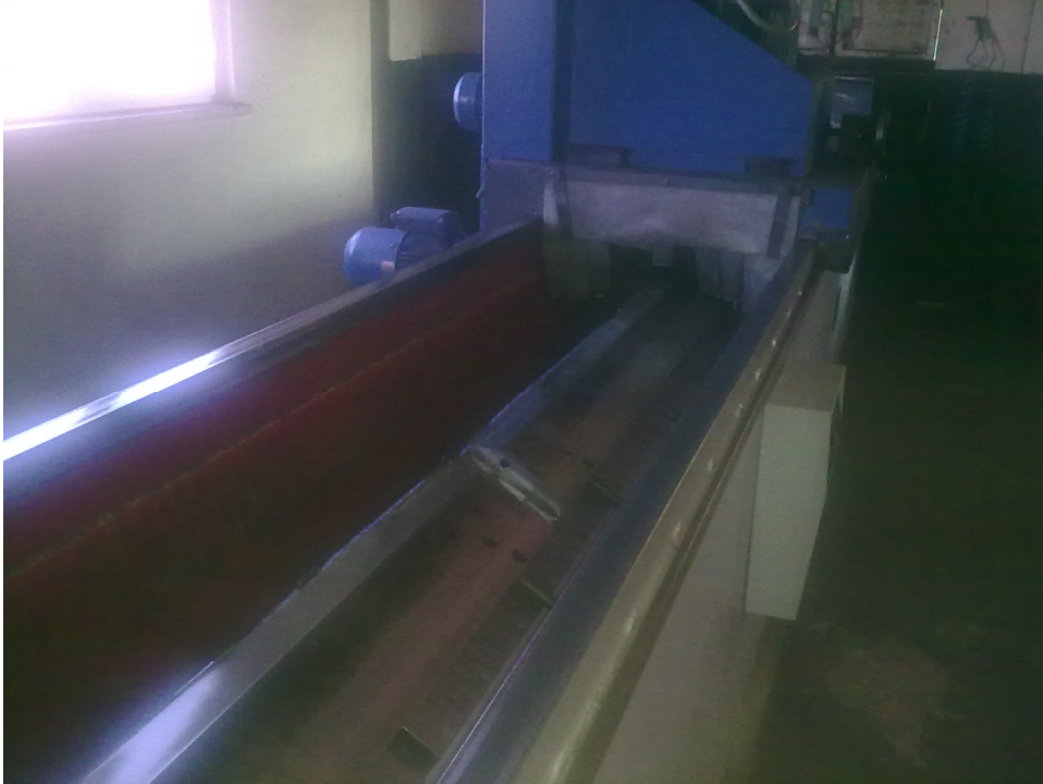
Şekil 5.4 Chipper Bıçak Bileme Robotu
