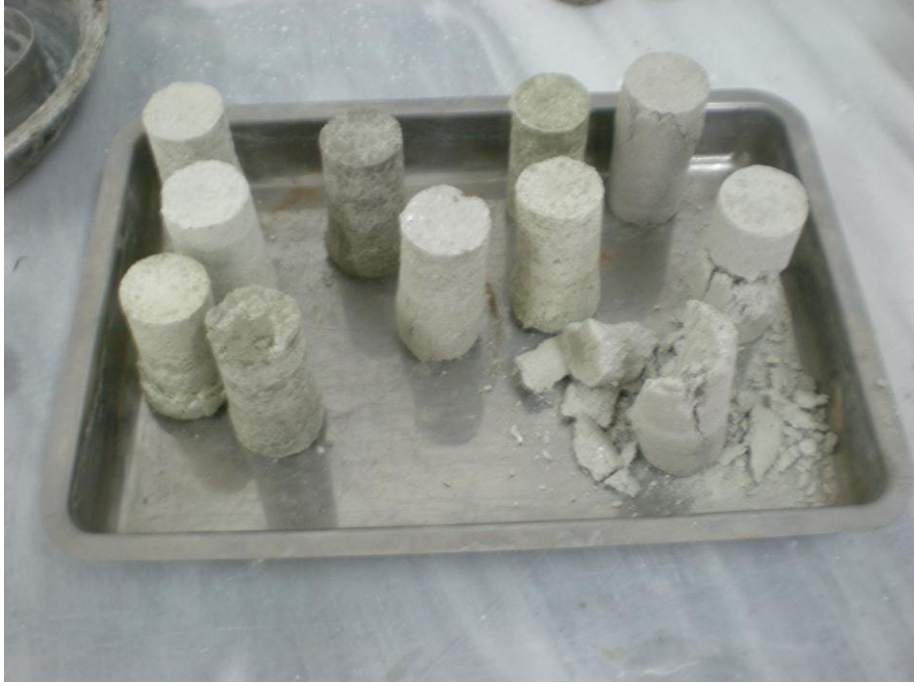
Şekil 6.8 Kırılmadan sonra numunelerin durumu
