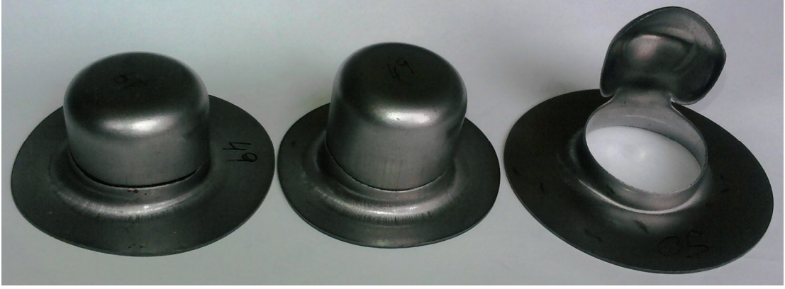
Şekil 5.31 75 mm çaptaki deney örneğinin 50 MPa hazne basıncında şekillendirilmesi sonucu oluşan kırılma çeşitleri.
