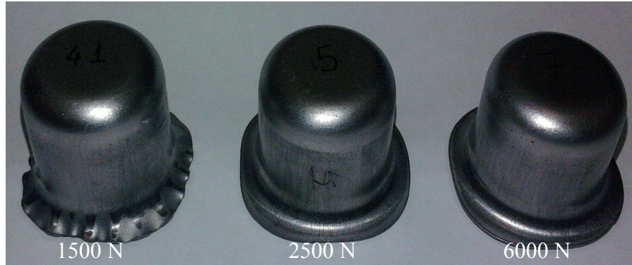
Şekil 5.40 Baskı yastığı kuvvetinin geleneksel derin çekme prosesine etkileri.
