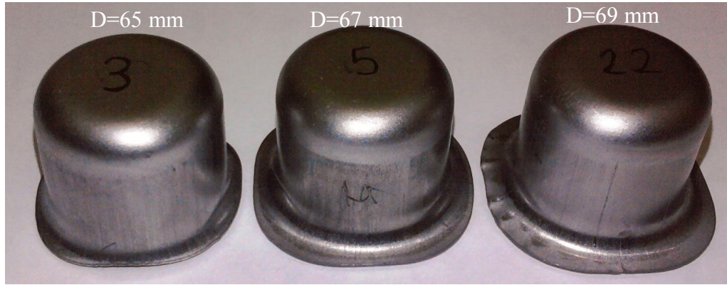
Şekil 5.47 İlk örnek çapının geleneksel derin çekme prosesine etkisi.
