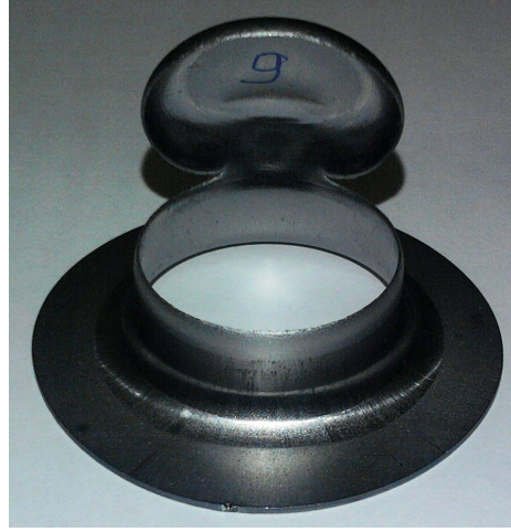
Şekil 5.41 6000 N baskı yastığı kuvvetinde şekillendirilmiş deney örneği.
