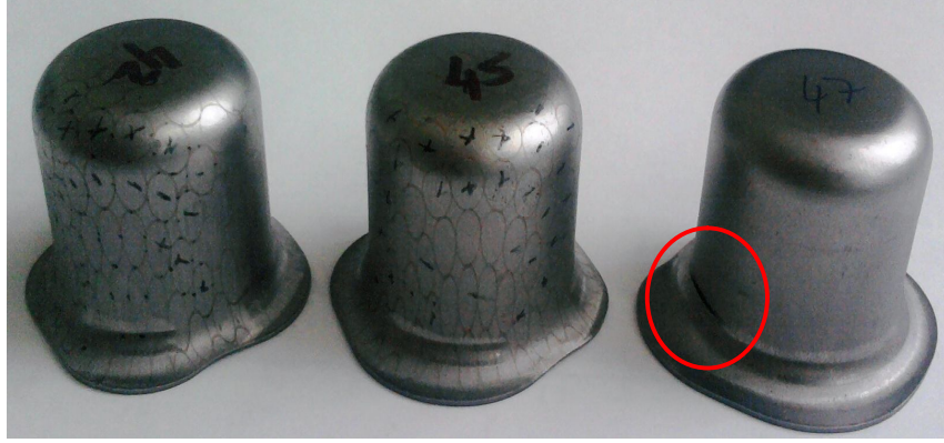
Şekil 5.18 71 mm çaptaki deney örneğinin 50 MPa hazne basıncında şekillendirilmesi.
