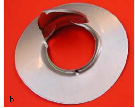
Şekil 3.28 a.Kısmen derin çekilmiş bir kutuda, baskı yastığı kuvvetinin yetersizliği nedeniyle, flanşta kırışma oluşumu [26], b.Baskı yastığı kuvvetinin gereğinden büyük olması nedeniyle derin çekilme sırasında kutunun kırılması [107].
