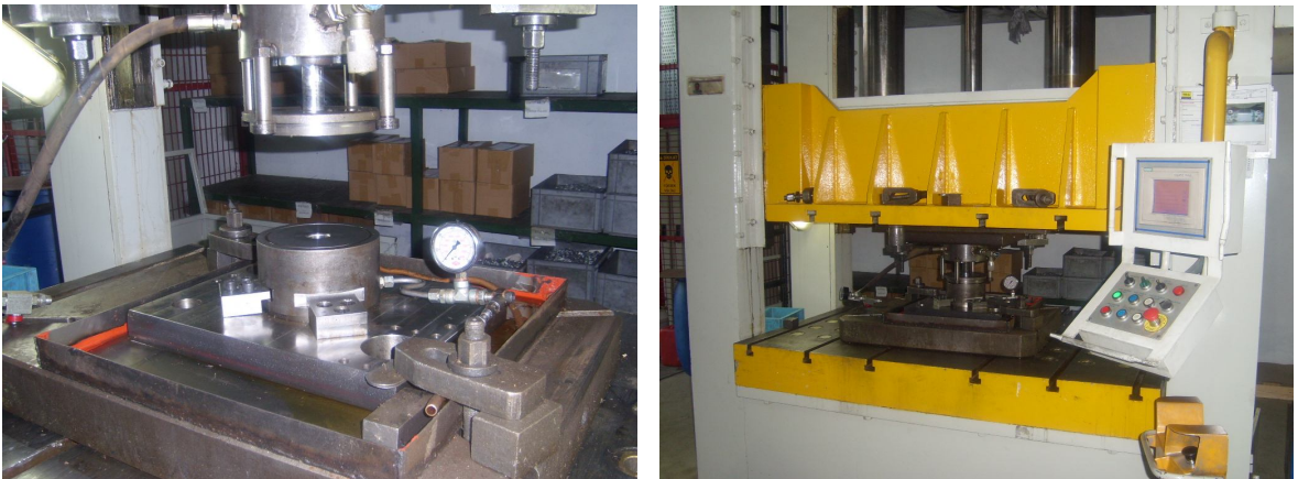
Şekil 4.14 Tasarlanmış deney düzeneğinin hidrolik prese montajı.
