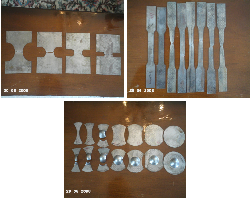
Şekil 5.3 DC04 sac malzemenin çekme makinesinde ve Erichsen makinesinde şekil değiştirmesi.
