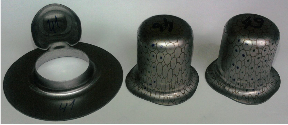
Şekil 5.30 75 mm çaptaki deney örneğinin 50 MPa hazne basıncında şekillendirilmesi.
