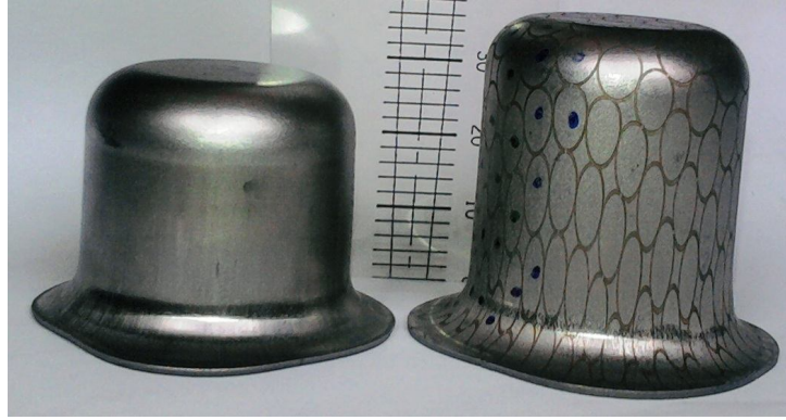
Şekil 5.53 Geleneksel ve hidromekanik derin çekme yöntemi ile üretilmiş örneklerin karşılaştırılması.
