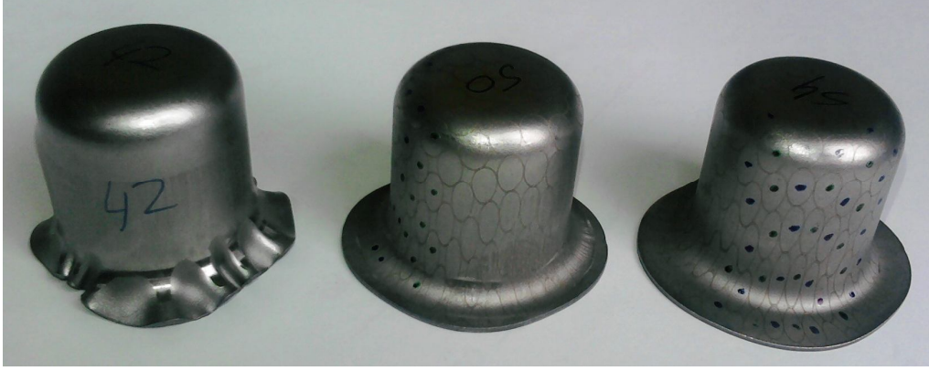
Şekil 5.24 73 mm çaptaki deney örneğinin 50 MPa hazne basıncında şekillendirilmesi.
