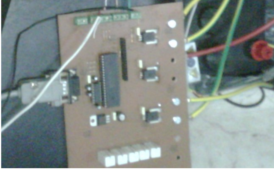
Şekil 4.13 PEM sisteminin performans ölçümüne yönelik mikrokontrolör denetimli ölçüm sistemi.
