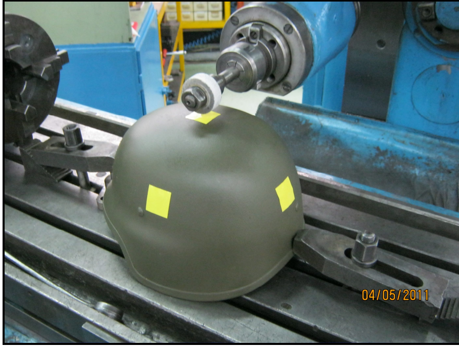
Resim 4.5: Kompozit başlığın freze tezgahına montajı
