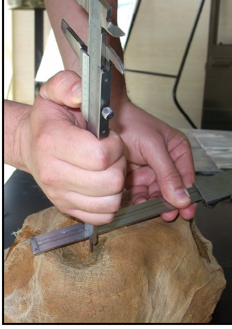
Resim 4.22: Cam macunu üzerinde oluřan derinliđin ölçümü
