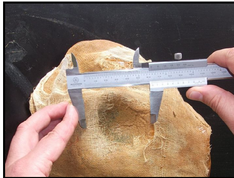
Resim 4.21: Cam macunu üzerinde oluşan genişliğin ölçümü
