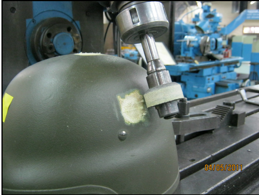
Resim 4.8: Kompozit başlıktan talaş kaldırma işlemi
