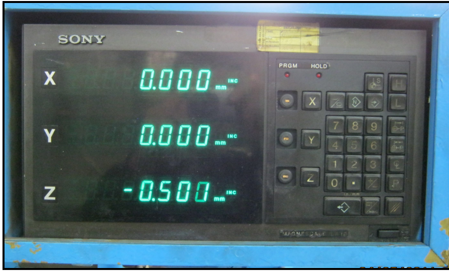
Resim 4.6: Digital koordinat okuyucu sisteme istenilen değerdeki ölçü girişi
