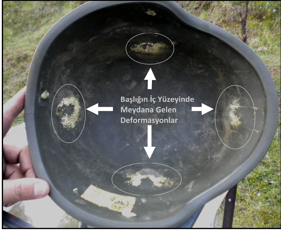
Resim 4.19: Başlığın iç yüzeyinde meydana gelen deformasyonlar
