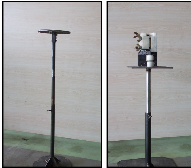
Resim 4.11: Kompozit başlık ve tabanca montaj aparatları
