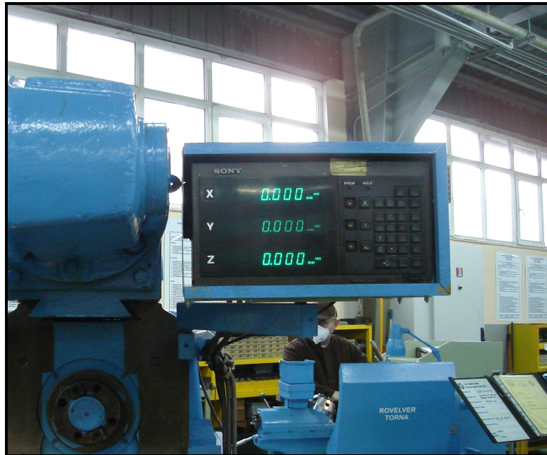
Resim 4.2: Üiversal freze tezgahı digital koordinat okuyucu sistemi
