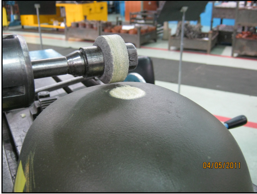
Resim 4.7: Kompozit başlıktan talaş kaldırma işlemi
