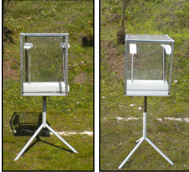
Resim 4.14: Atışlı testlerde kullanılan kronograf ve ekipmanı
