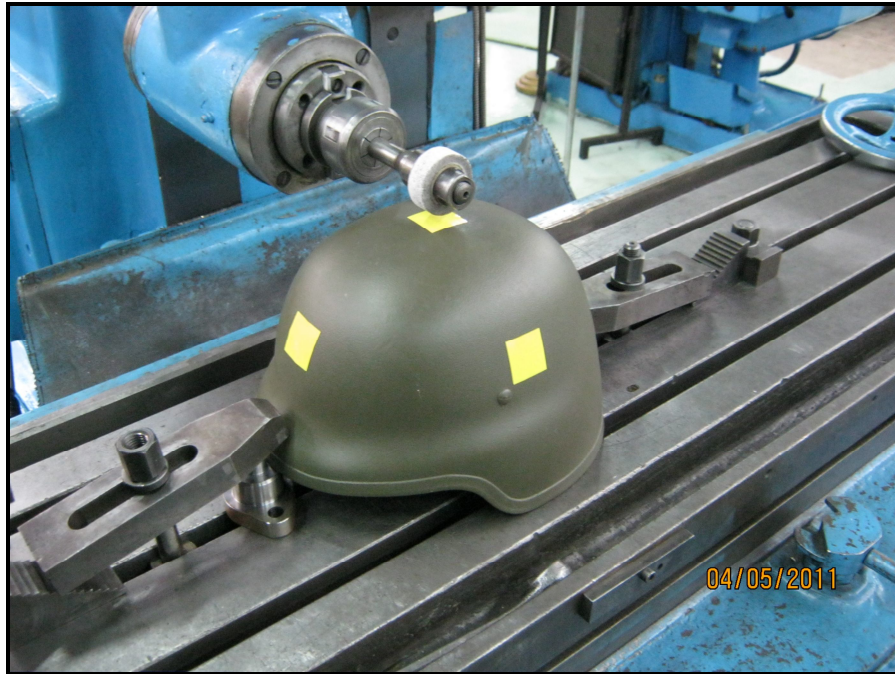
Resim 4.4: Kompozit başlığın freze tezgahına montajı
