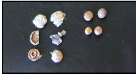
Resim 4.20: Balistik test sonrası mermi çekirdeklerinin görünümü
