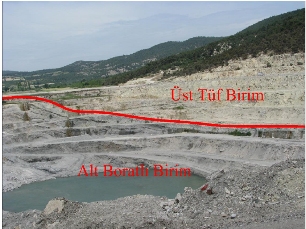
Şekil 2.4: Alt Boratlı Birim ile üzerindeki gri yeşil renkli Üst Tüf birimi arasındaki stratigrafik ilişki. Tülü açık işletmesi.
