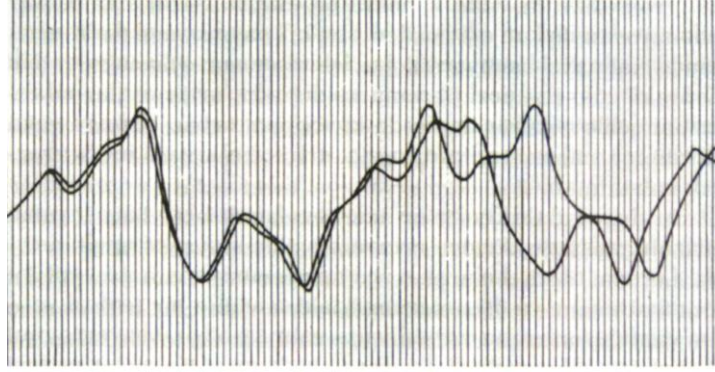
METEOROLOJİK İKİ ŞEKİL BİRBİRİNDEN NASIL UZAKLAŞIR. Edward Lorenz, bilgisayarının çizdiği hava durumuna ilişkin şekillerin, hemen hemen aynı çıkış noktasından hareket etmelerine rağmen birbirlerinden gittikçe uzaklaştıklarını, hatta sonunda aralarındaki benzerliğin de tamamen yok olduğunu gözlemiştir (Lorenz'in 1961 yılında aldığı bilgisayar dökümlerinden.)
