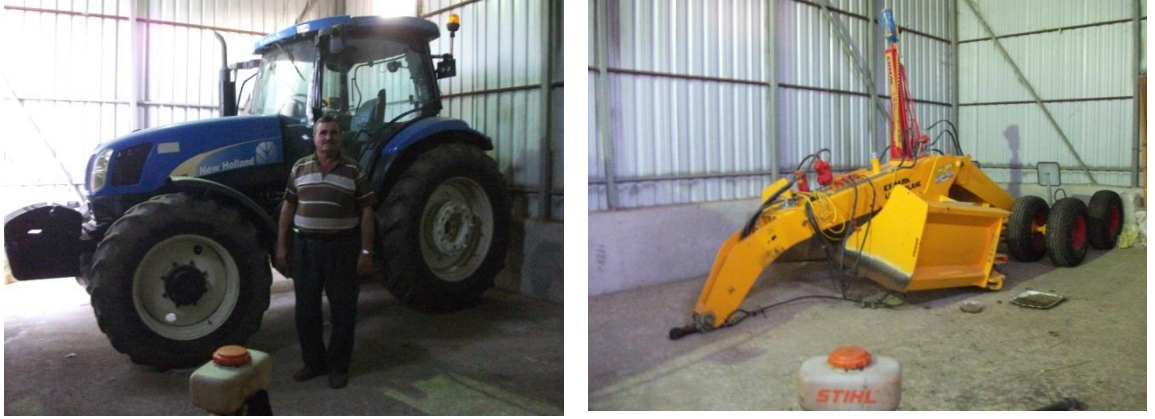
Şekil 23-24: Hasan Akın ve Çeltik Tarımında Kullanılan Traktör ve Lazer Tesviye Makinesi
