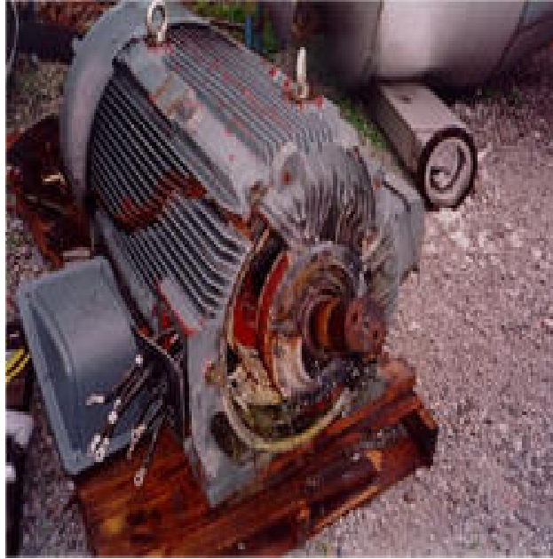
Şekil 1.2 Arızalanan Bir Motor
