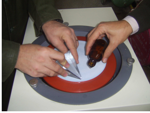
Şekil 2.62 Keçe ile parlatma işlemi
