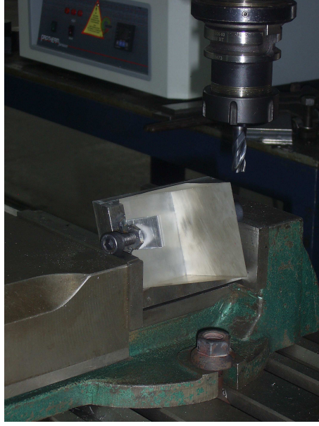
Şekil 2.58 Malzemenin frezeze yerleştirilmesi
