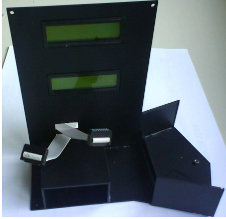
Şekil 2.77 LCD 'lerin monte edilmesi
