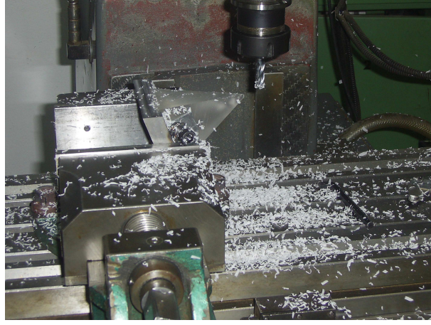
Şekil 2.60 Malzemenin diğer yüzeyinin işlenmesi
