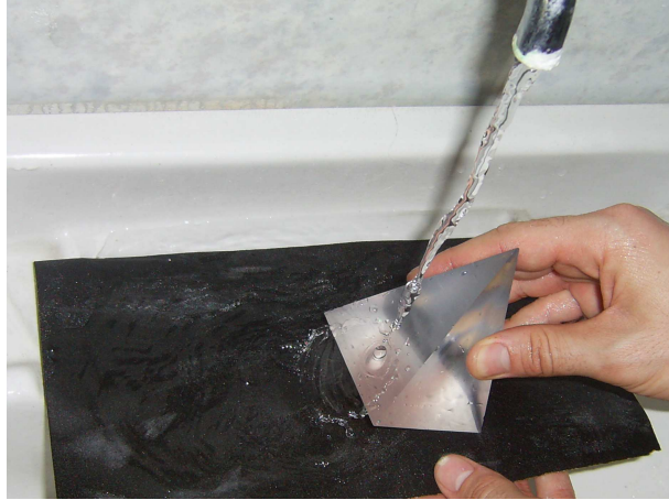
Şekil 2.61 Su altında zımparalama işlemi
