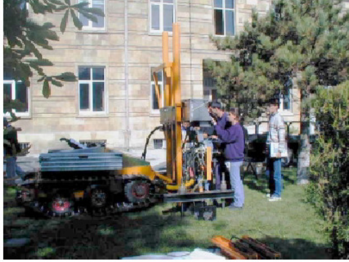
Şekil 7.3.1 Anadolu Üniversitesinin SCPT sondaj aleti [54]
