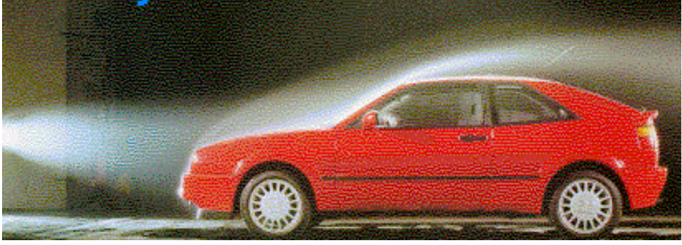
Şekil 3.18 Rüzgâr tüneline Volkswagen otomobilin üzerindeki hava akış şekli
