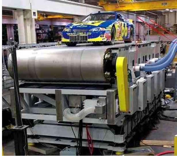
Şekil 3.10 Hareketli kayış mekanizması (rüzgâr tüneline yerleştirilmemiş)
