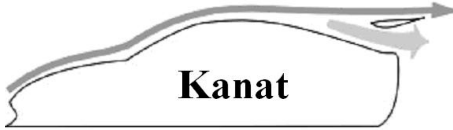
Şekil 2.10 Hava kanadının hava akımını yönlendirişi
