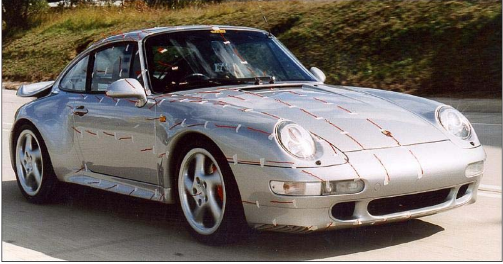
Şekil 3.15 Otomobilin üzerindeki akış yönüyle kolayca bükülebilen püsküller
