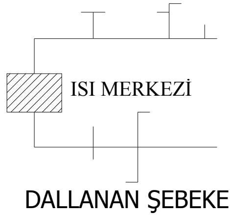
Şekil 3.1 Dallanan Tip Şebekenin Şematik Gösterimi [47].
