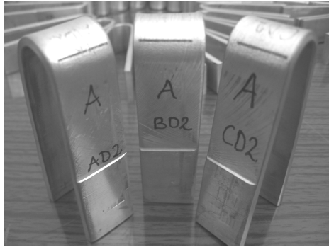
Şekil D.1 180° Eğme (katlama) deneyi yapılmış numune resimleri.
