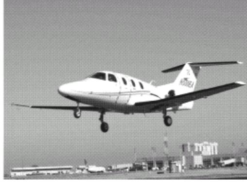
Şekil 4.13 Birleştirmelerinde büyük oranda SKK kullanılan ilk uçak [4].
