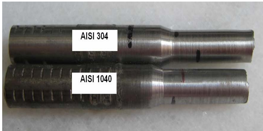
Şekil 4.11 4- Numaralı Deney Numunesinin Kopma Resmi
