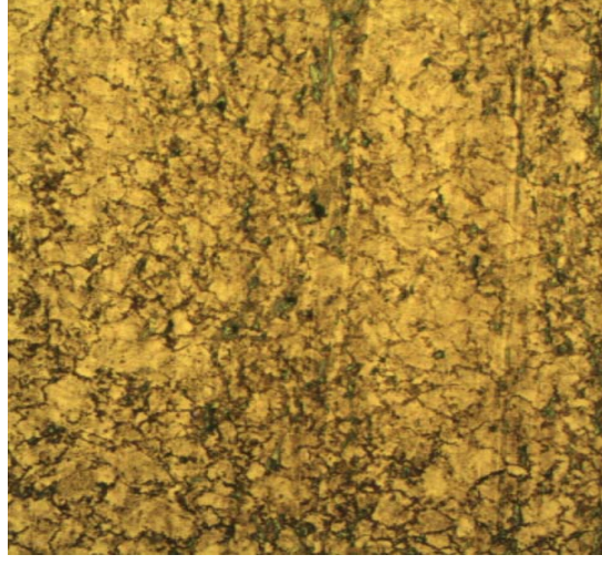
Şekil 4.34 6- Numaralı Deneysel Numunesinin 200X Büyüklüğündeki Optik Mikroskop Görüntüleri ( P_1=15 \text{ daN/cm}^2 , P_2=20 \text{ daN/cm}^2 )
