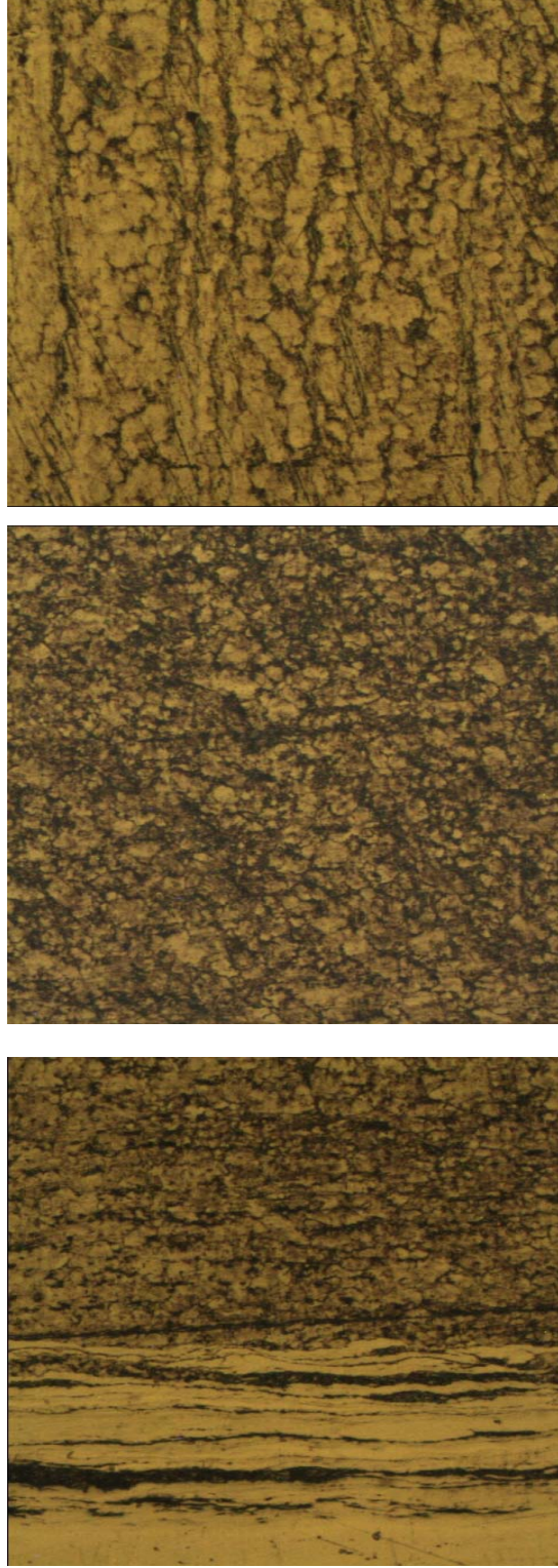
Şekil 4.32 4- Numaralı Deneysel Numunesinin 200X Büyüklüğündeki Optik Mikroskop Görüntüleri ( P_1=10 \text{ daN/cm}^2 , P_2=20 \text{ daN/cm}^2 )
