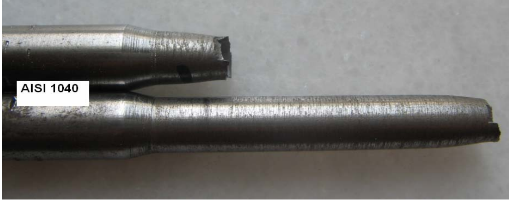
Şekil 3.7 AISI 1040 Çeliğinin Kopmuş Çekme Numunesi
