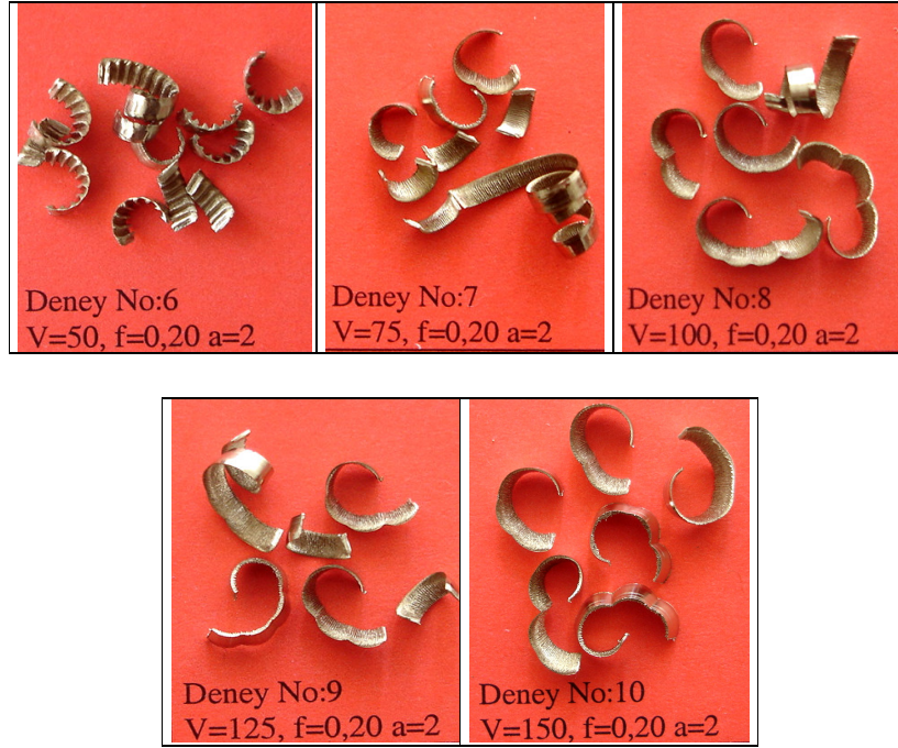
Şekil Ek 4.2 İlerlemenin 0,20 mm/d, Talaş Derinliğinin 2 mm Ve Farklı Kesme Hızlarında, İşlenen Deney Numunelerinden Elde Edilen Talaşların Görüntüleri
