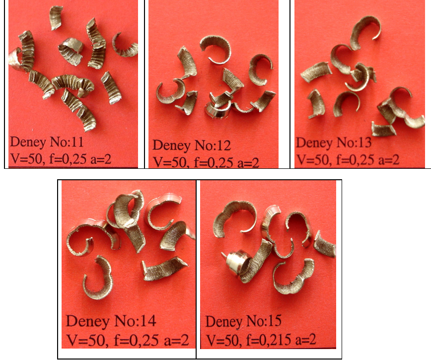
Şekil Ek 4.3 İlerlemenin 0,25 mm/d, Talaş Derinliğinin 2 mm Ve Farklı Kesme Hızlarında, İşlenen Deney Numunelerinden Elde Edilen Talaşların Görüntüleri
