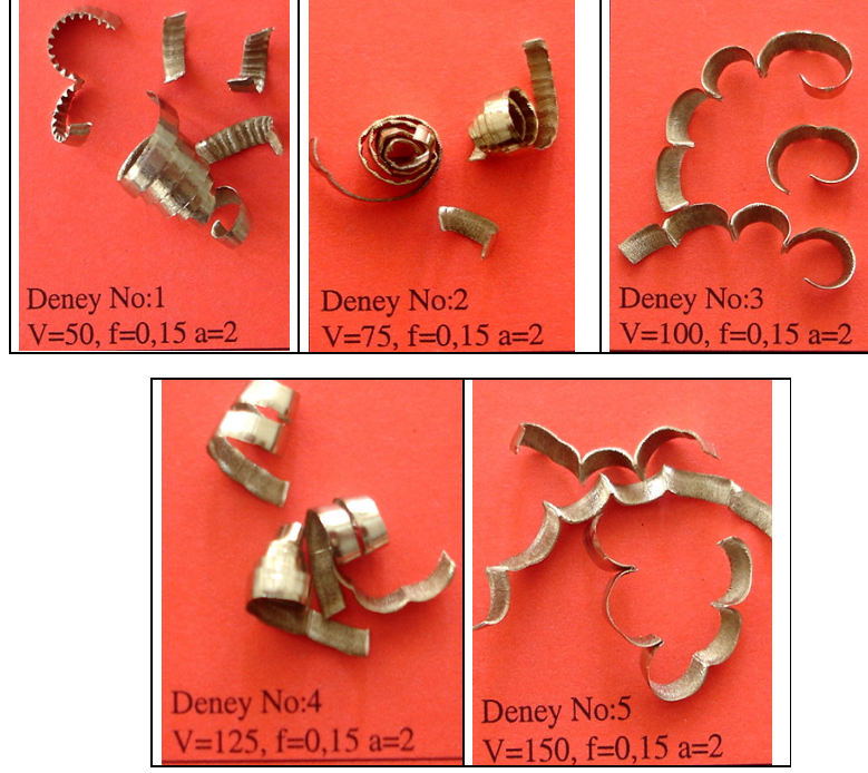
Şekil Ek 4.1 İlerlemenin 0,15 mm/d, Talaş Derinliğinin 2 mm Ve Farklı Kesme Hızlarında, İşlenen Deney Numunelerinden Elde Edilen Talaşların Görüntüleri
