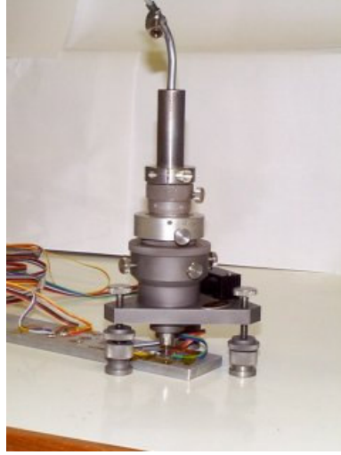
Şekil 4.2. Delik Delme Yöntemi İle Kalıcı Gerilme Ölçebilen Cihaz [108]
