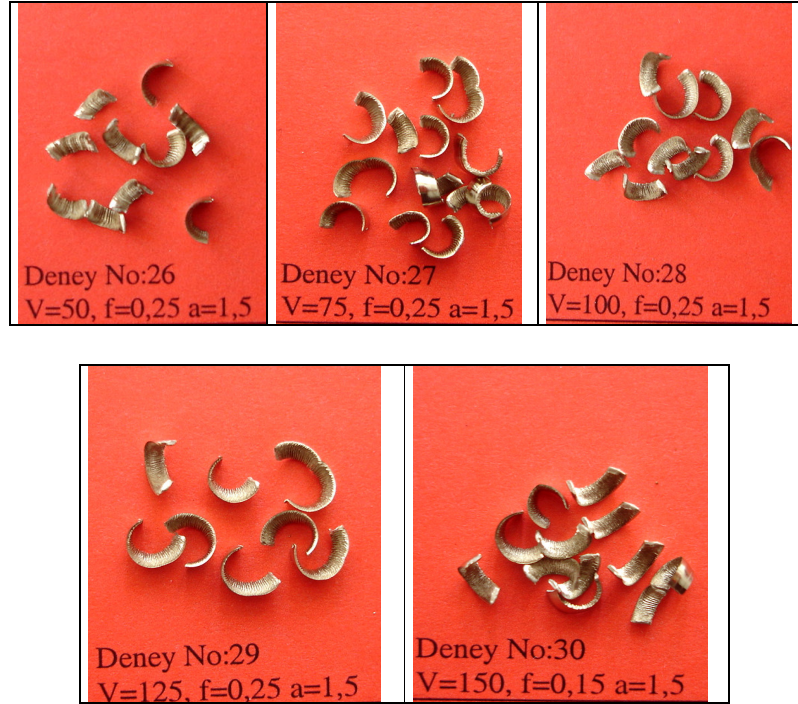
Şekil Ek 4.4 İlerlemenin 0,25 mm/d, Talaş Derinliğinin 1,5 mm Ve Farklı Kesme Hızlarında, İşlenen Deney Numunelerinden Elde Edilen Talaşların Görüntüleri
