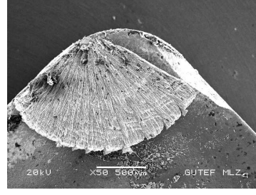
Şekil 6.6 Kesme Hızı 50 m/dk İle İşlenen Deney Numunesinde Kullanılan Kesici Uç Radyusu Üzerinde Oluşan BUE
