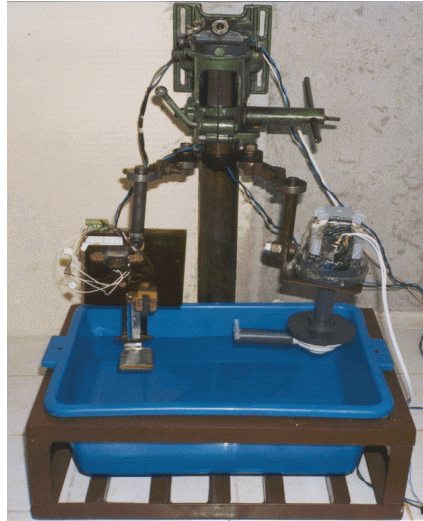
Şekil 5.6 Katman Kaldırarak Kalıcı Gerilme Ölçme Deney Düzeneği
