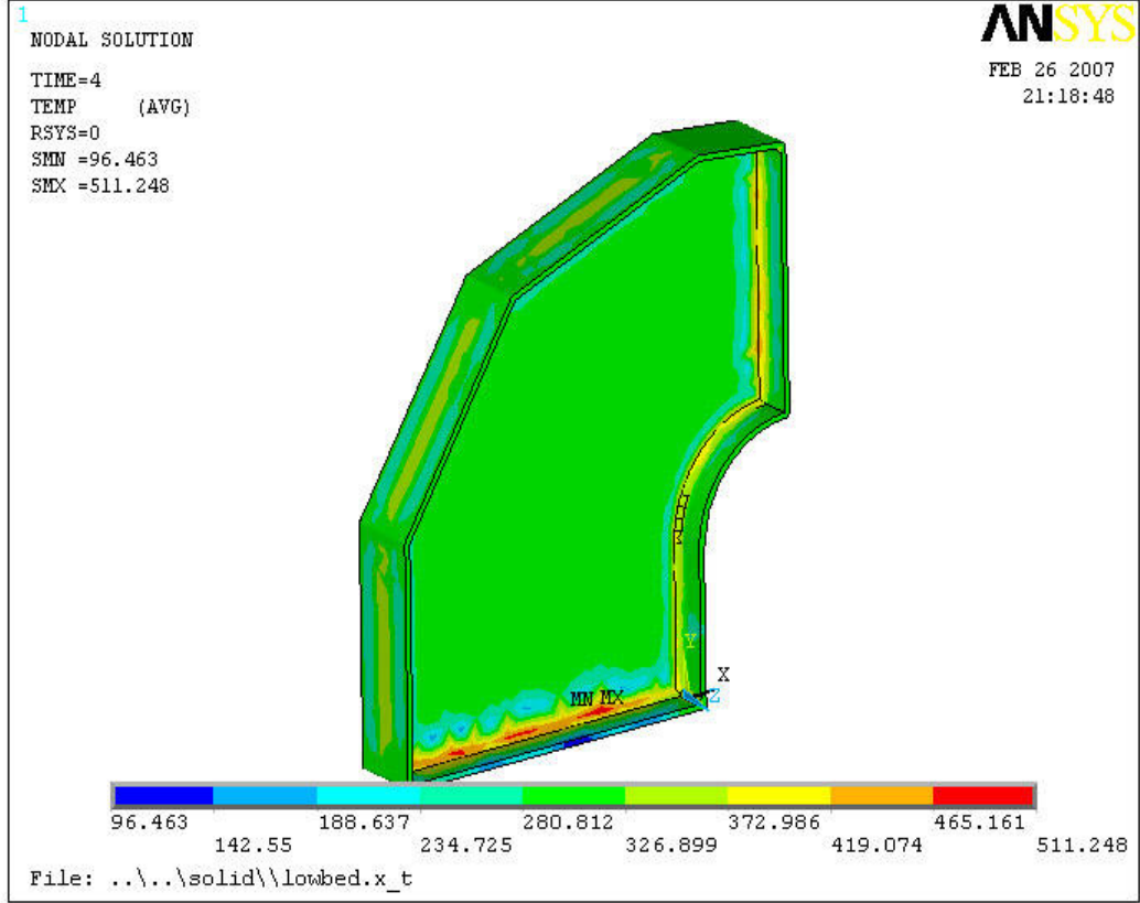
Şekil 4.29 Boyun bölgesinde 4 sn sonraki sıcaklık dağılımı (birleşim bölgesi)
