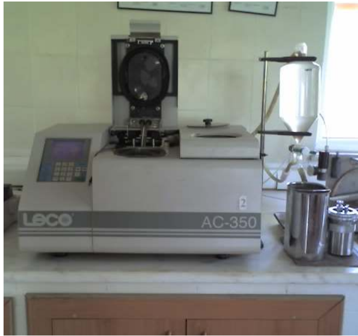
Şekil 2.6 Kömür kalori ölçüm cihazı
