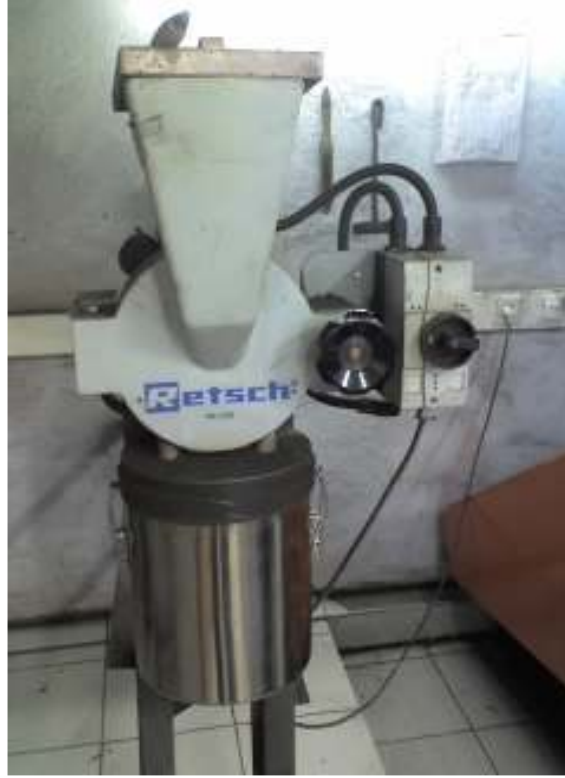
Şekil 2.1 Numune hazırlama esnasında kullanılan kömür öğütme cihazı
