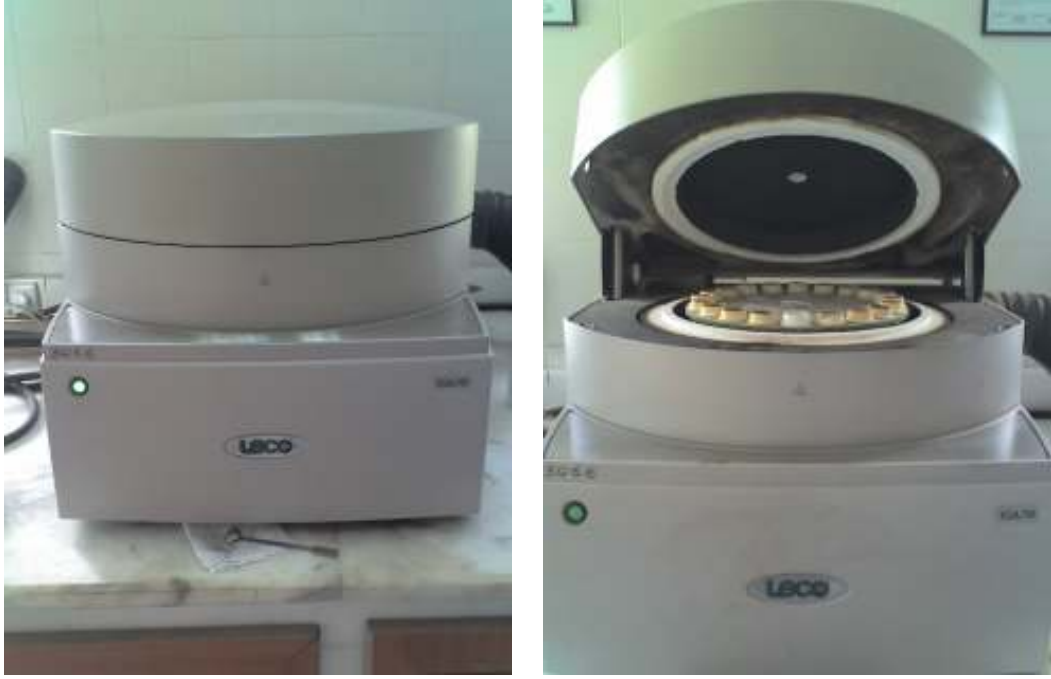
Şekil 2.5 Kömürün uçucu madde ve kül/nem miktarı ölçüm cihazı
