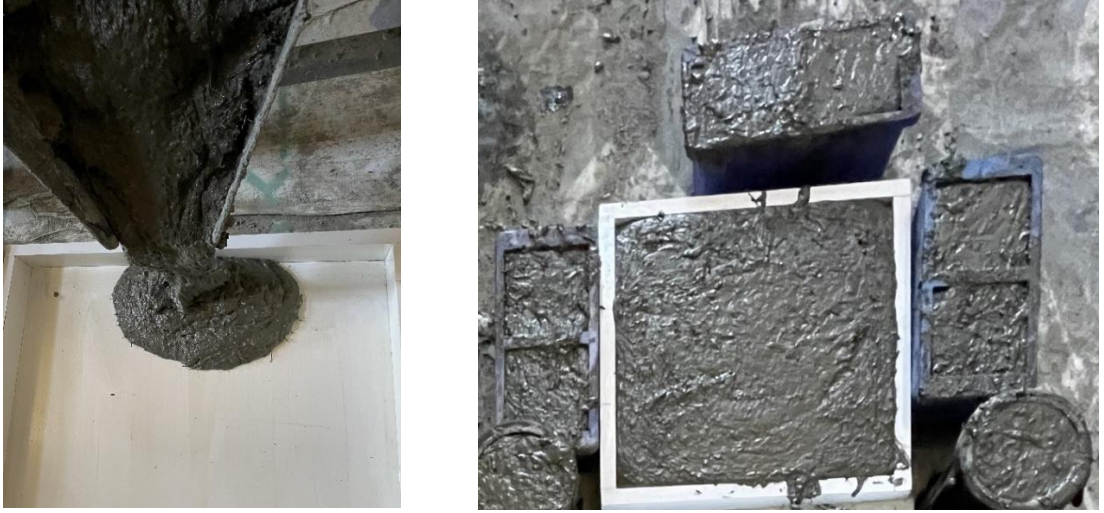
Şekil 3.13: Betonun kalıplara yerleştirilmesi.
