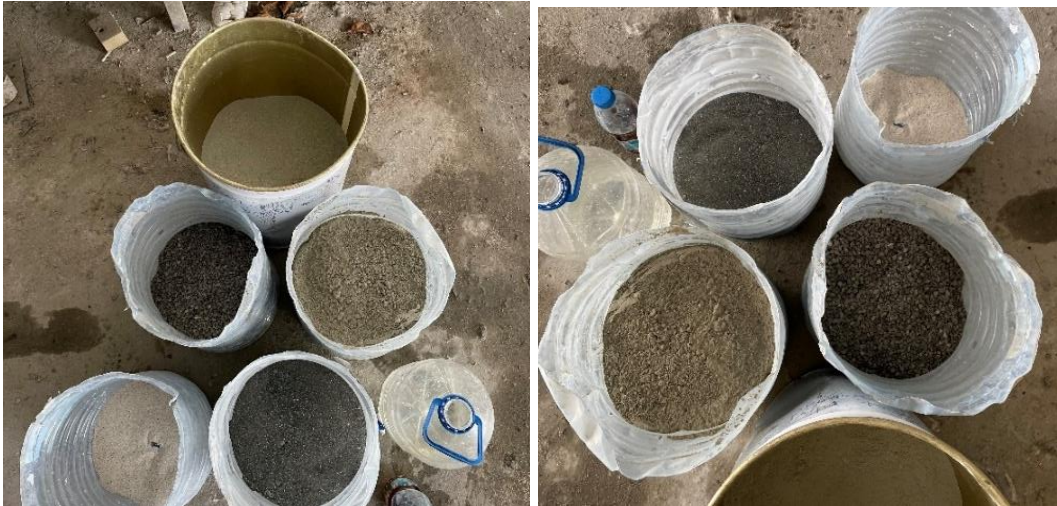
Şekil 3.9: Betonda kullanılacak tartımı yapılmış malzemeler.
