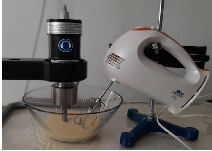
Şekil 3.1: Kek hamuruna ultrason uygulama.
